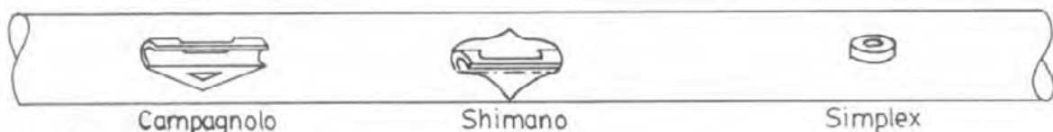
ill. 20: brazed-on front derailleurs
