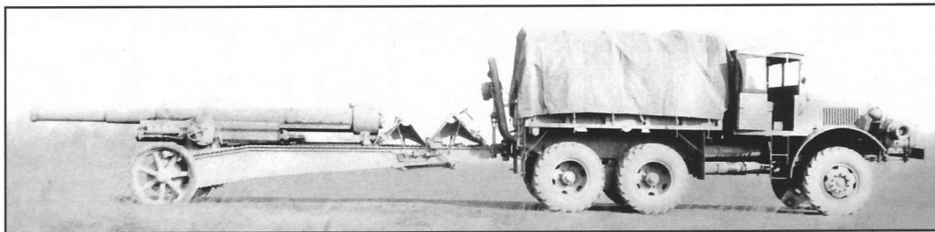
Version finale du Mack NO, il a perdu son toit tôle et le treuil est passé sous le pare-chocs. C'est 2.080 exemplaires qui seront commandés par l'armée. (Photo Coll. JM Boniface)
