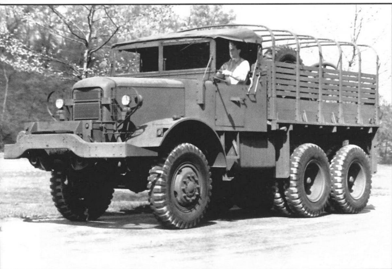
Version finale du Mack NO, il a perdu son toit tôle et le treuil est passé sous le pare-chocs. C'est 2.080 exemplaires qui seront commandés par l'armée. (Photo Coll. JM Boniface)
