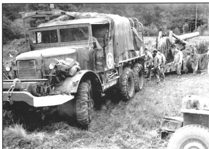
Mise en batterie d'un 8" Howitzer dans la région de Rambervillers en France en ce 29 octobre 1944. La mobilité de l'ensemble est augmentée par la mise en place de chaînes sur l'ensemble des roues du camion. (Photo US Army SC-195817)
