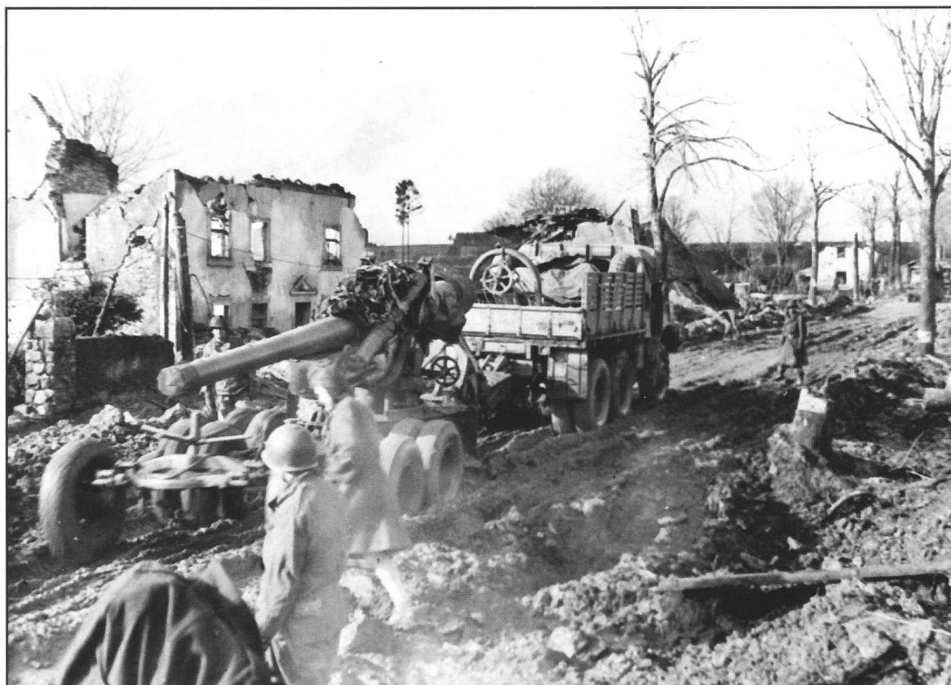
Belgique fin 1944. Par facilité l'avant train du 155 est ici tiré en remorque derrière le canon et comme chaque fois l'intérieur de la caisse cargo est plein de matériel et d'effets personnels. (Photo Office of War Information EA-52527)
