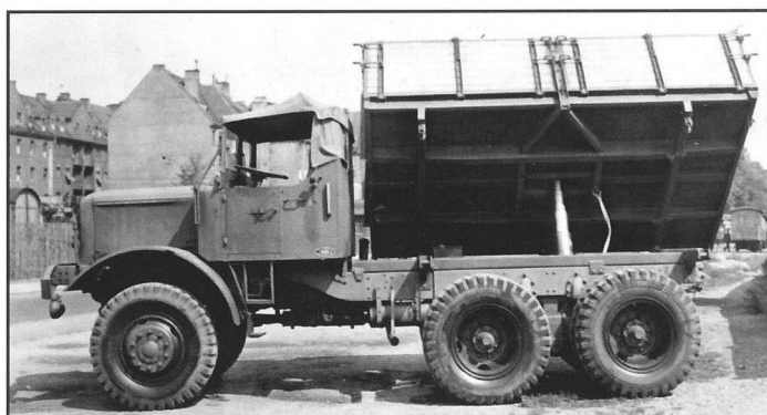
Les établissements Meiller de Munich (D) se sont spécialisés après guerre dans la transformation des véhicules lourds US en engins de chantier.
