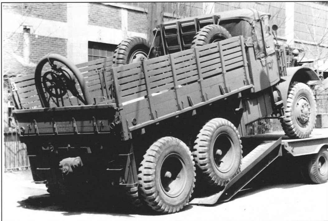
L'arrangement de la caisse cargo est très spécifique, les banquettes n'occupent que 3/5 de la longueur des ridelles latérales. Le portique de levage de la version de série prend appui sur le châssis au travers de la caisse. (Photo Coll. JM Boniface)
