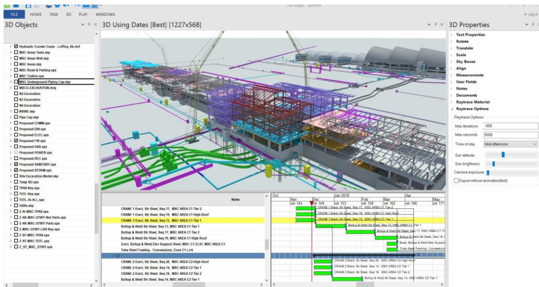
Hình 1.9 Lập tiến độ dựa trên mô hình BIM
