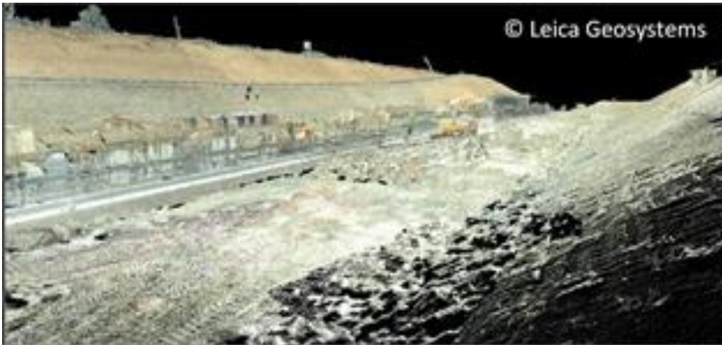
Hình 1.3 Biểu diễn đám mây điểm 3D từ quét laser trong phần mềm
