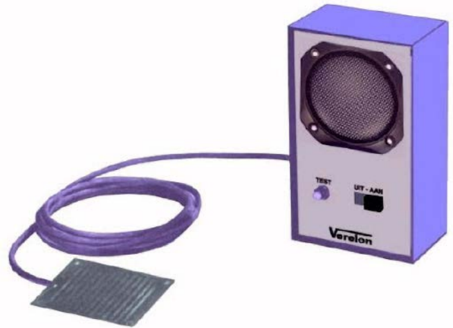
Rysunek 8. Alarm deszczowy działający na zasadzie rezystancyjnej (© 2020 Jos Verstraten)
