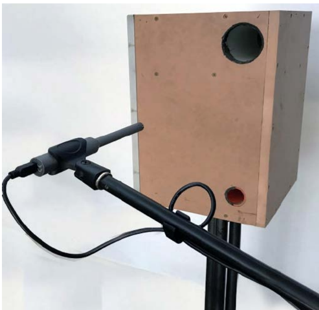
Rysunek 12. Jeśli nie masz komory bezchowej, ale chcesz dokładnie scharakteryzować odpowiedź głośnika na dostarczane do niego sygnały, musisz albo zrobić to w otwartej przestrzeni, albo wykonać pomiary „bliskiego pola”, jak pokazano na fotografii. Polega to na umieszczeniu mikrofonu bardzo blisko głośnika, tak, aby odbite fale dźwiękowe były na bardzo niskim poziomie w porównaniu z bezpośrednio mierzonym dźwiękiem, a tym samym nie wpływały nadmiernie na wyniki. Test ten został przeprowadzony przed ostatecznym wykończeniem obudowy pokryciem
