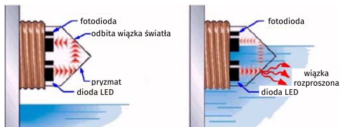
Rysunek 17. Działanie czujnika elektrooptycznego (© eptsensor.com)
