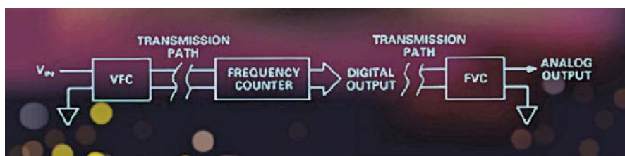
Rysunek 1. Schemat blokowy transmisji z wykorzystaniem przetwornika napięcie-częstotliwość
