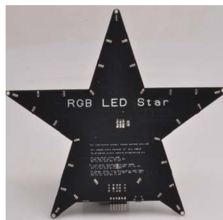
Rysunek 3. Tył Gwiazdy RGB LED nie pozostawia wątpliwości, która to wersja! Ale co ważniejsze, zawiera instrukcje dotyczące uruchamiania gwiazdy w różnych trybach
