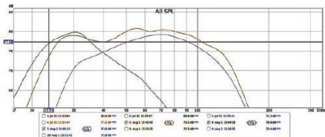
Rysunek 4. Tutaj pokazana jest emisja dźwięku z dwóch tuneli kolumny (opis w tekście) wraz z ogólną charakterystyką subwoofera. Daje to wyobrażenie o tym, jak dwie oddzielne wnęki i tunele przyczyniają się do rozszerzonej płaskiej charakterystyki subwoofera
