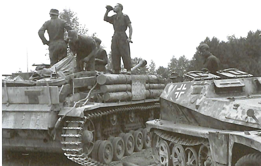
▲ Un StuG III Ausf. G lors d'un ravitaillement en munitions par un Sd.Kfz. 252 lors de l'été 1944. Notez la présence de troncs d'arbre fixés sur le côté droit du canon d'assaut. À la mode soviétique, ils pallient la mauvaise motricité du train de roulement, handicapé par ses chenilles larges de seulement 40 cm, sur sol peu porteur.
