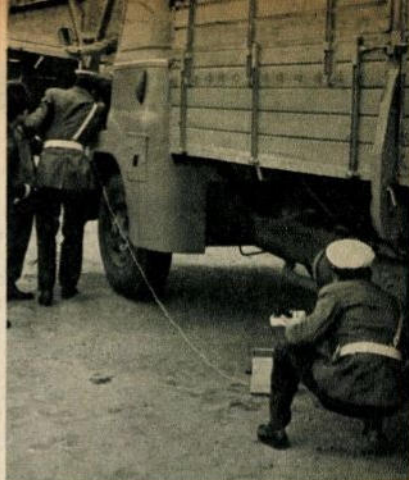
A Mechanikai Művek FA-19-37-es teherautójának füstvizsgálatánál annyira el-sötétedett a szűrőlap, hogy ilyen erős szennyezettségi fokot még az összehasonlító színskálán sem találtak! (Kollányi Gyula felvétele)
