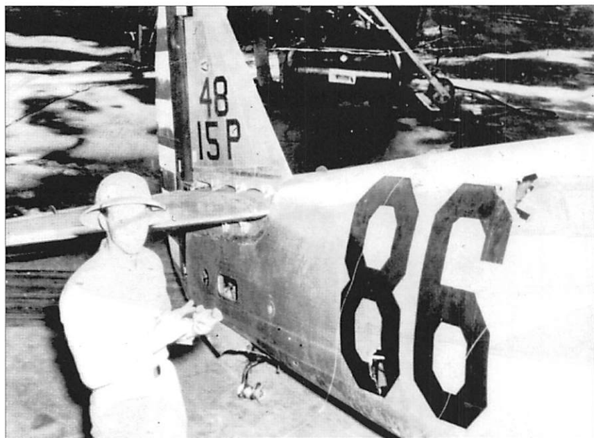
Le 2nd Lieutenant Phil Rasmussen devant son « 86 ». On note que la roulette de queue a été arrachée par un projectile. On voit aussi un bel impact de 20 mm dans le fuselage. (Collection R. Darcey)
