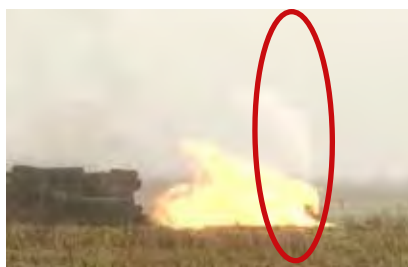
Essai de brûlage véhicule GNL (torchère en haut)
