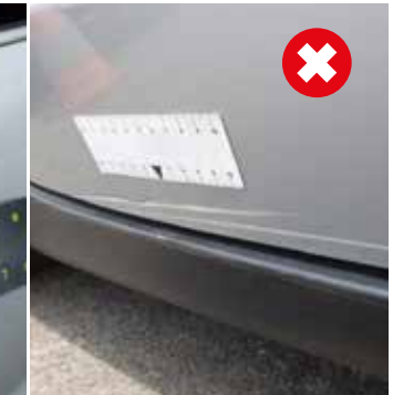
Eclat de diamètre ≥ 4 mm ou si plus de 5 éclats sur un même élément.
