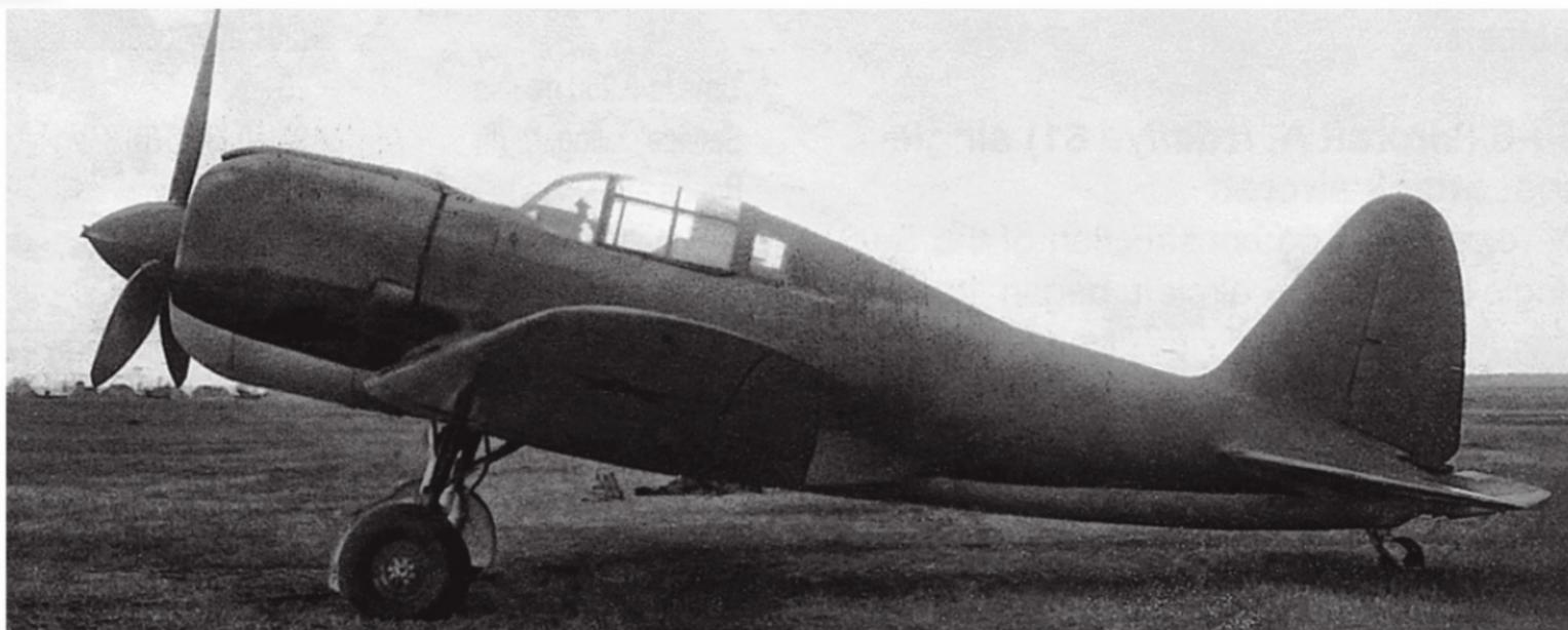
◀ & ▼ Le prototype Su-6(A) après qu'il a subi certaines modifications à l'été 1941, comme celle de la prise d'air de capot pour la carburation, moins proéminente, mais élargie. Les bouches des mitrailleuses d'aile sont bien visibles, mais les plans de la voilure ne sont pas équipés des becs automatiques prévus originellement. (Marmain)
