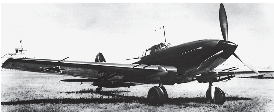
◀ Un II-10M fraîchement sorti d'usine. Il se différencie surtout de l'II-10 par sa nouvelle voilure aux saumons rectilignes et ses quatre canons NR-23. L'emport de lance-roquettes est limité à quatre. Son antenne fixée sur l'arceau du pare-brise et l'absence de quille sous l'arrière du fuselage indiquent qu'il s'agit d'un des tous premiers II-10 construits. (Marmain)
