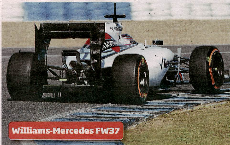
Wieder keine Stelzen: Der Heckflügel am Williams FW37 stützt sich auf den Endplatten ab
