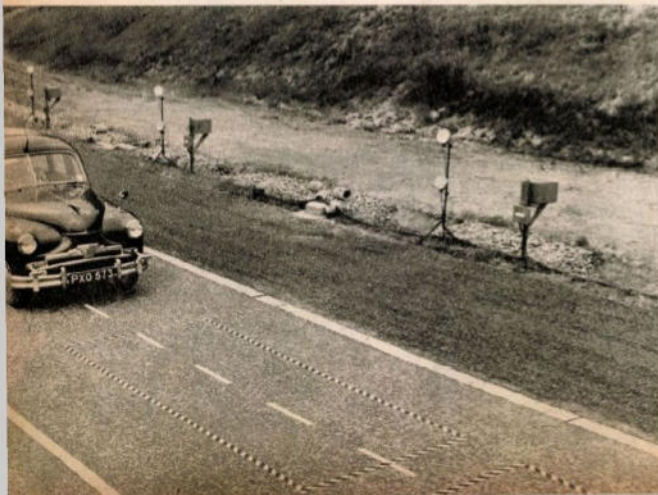
Az angol Road Research Laboratory építette ki ezt az elektronikus riasztóznát annak a vizsgálatára: miként lehetne elkerülni — jelzők és jelfogók alkalmazásával —, hogy az autók rendkívül körülmények között egymásba fussanak
