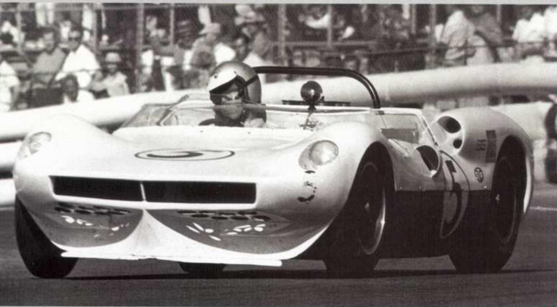
◀シャバラル2(1963)。'63年10月リバーサイドでの「2」デビュー戦。見るからにリフトが大きいようなノーズ形状はこの後どんどん改良されていく。5.4ℓシボレーV8をミッドシップとし、斬新なFRP製モノコック・シャシーがディを保持していた。有名なオートマチック・ミッションを使うようになるのは、'64年半ば以降のこと。後に「2A」と呼ばれることが多いが、本来は単に「2」だ。'64-'65年と「2」はアメリカのスポーツカー・レースを興隆させた
