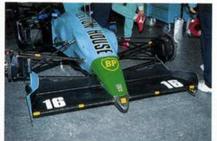
ウイングに変更はないが、ノーズ部を太くし走行安定性を求めている
