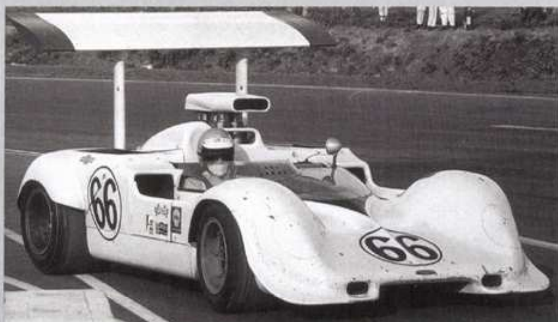
▲シャバラル2G (1968、右上)、2H (1969、左上)、2J (1970、左下)。'60年代後半のCan-Amシリーズには世界中のトップドライバーが参戦し、高額賞金を狙って激戦を演じた。マクラレンやローラなどイギリス製シャーシが盛況をふるい、フェラーリやポルシェも参戦する中、地元アメリカ期待のマシンはやはりシャバラルだった。2Eの改良発展型2Gは'67-68年と活躍。しかしホールは'68年最終戦ラスベガスで両足骨折の重傷を負ってしまい、ドライバー生活にピリオドを打つ。'69年デビューの2Hは「オープン・クーペ」とも呼ばれた通称重視のユニークなボディ・スタイルと変形ドynamo・サスが特徴。そして2Jはボディ下面を密閉し、後部に小型エンジンを別搭載し空気を吸ってダウンフォースを得る画期的なアイデアを用いて、人々の度胆を抜いた
