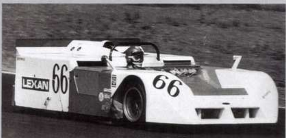
▲シャバラル2G (1968、右上)、2H (1969、左上)、2J (1970、左下)。'60年代後半のCan-Amシリーズには世界中のトップドライバーが参戦し、高額賞金を狙って激戦を演じた。マクラレンやローラなどイギリス製シャーシが盛況をふるい、フェラーリやポルシェも参戦する中、地元アメリカ期待のマシンはやはりシャバラルだった。2Eの改良発展型2Gは'67-68年と活躍。しかしホールは'68年最終戦ラスベガスで両足骨折の重傷を負ってしまい、ドライバー生活にピリオドを打つ。'69年デビューの2Hは「オープン・クーペ」とも呼ばれた通称重視のユニークなボディ・スタイルと変形ドynamo・サスが特徴。そして2Jはボディ下面を密閉し、後部に小型エンジンを別搭載し空気を吸ってダウンフォースを得る画期的なアイデアを用いて、人々の度胆を抜いた
