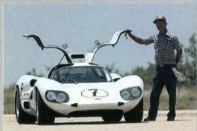
▲ガルウイング・ドアを開けた2 D。ルーフ上のエアスクープがユニーク。トロイ・ロジャース・メカが今もここで働いている
