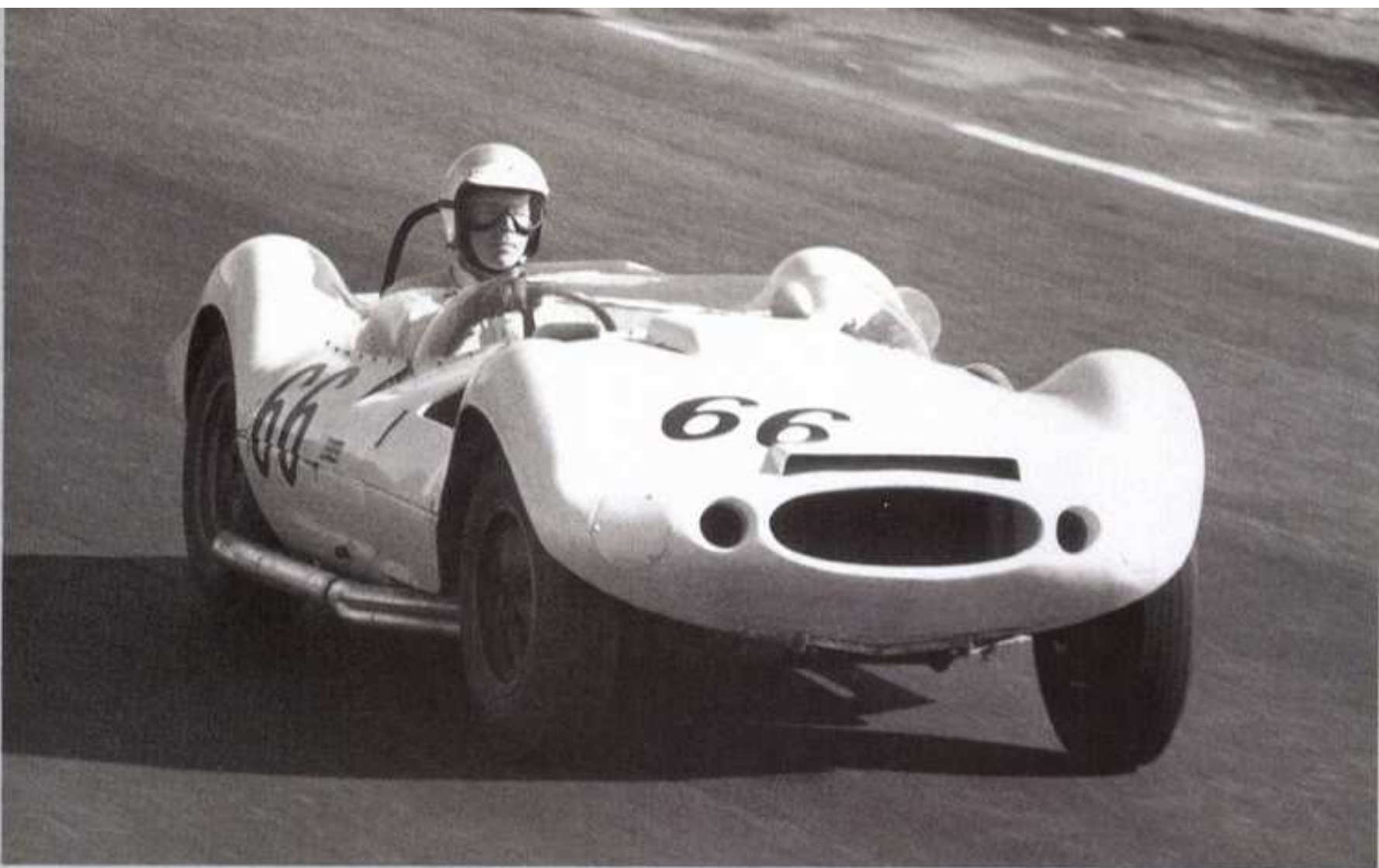
▶シャバラル1(1962)。最初のシャバラルは61年半ばに登場したフロント・エンジン・スポーツカーだった。ジム・ホルの依頼でトラウトマン&パーズ社が製作したもの。同社の前作「スカラブ」にも似る。5.2ℓシボレーV8を搭載して活躍したが、時代は急速にミッドシップ化を突き進んでいた。シャバラルがテキサス州ミッドランドで会社組織になる以前の、言わば習作ともいえるモデルだ。カーナンバー66は彼がアマチュア時代から愛用していた
