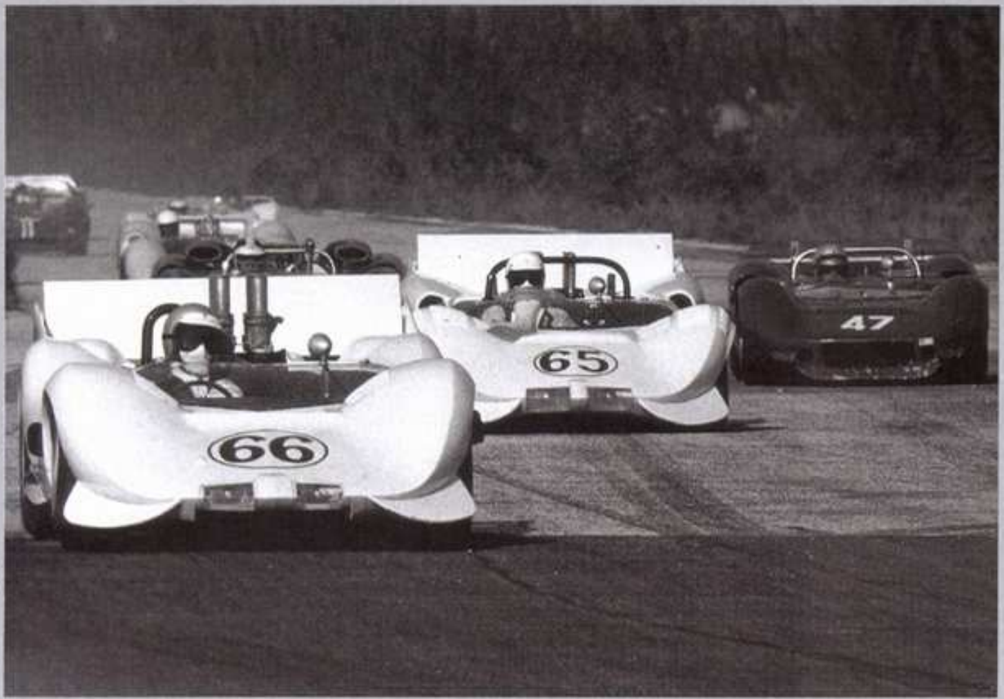
▶2C (No.66=ジム・ホール) と2 (No.65=ハブ・シャープ)、'65年末のナツゾーでの首位争い。2Cはアルミ・モノコックとリヤの可動エアスポイラー（「フリッパー」）が特徴。この時期には2もかなり進化して、外観上は2Cとはほとんど区別がつかない。右側のNo.47はブルース・マクラレン選手をマクラレンM1Bで、シャバラルにとっての最大のライバルだった。リゾート地として著名な西インド洋バハマ諸島ナツゾーでは毎年冬に盛大にレースウィークが開催された。
