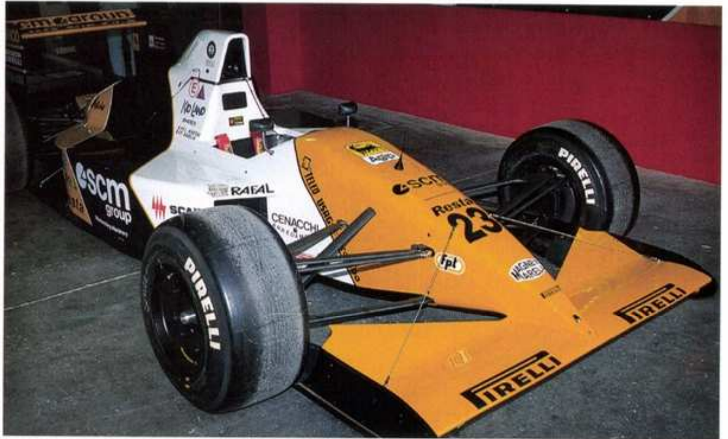
フロントウイングが大型のシングルプレートに、そしてF1マシンで初めて折りをつける試みをしている
