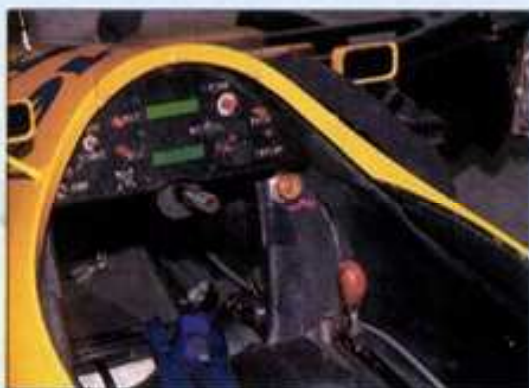
ロータス102のコクピット周り。フットスペースには、ロールオーバーも兼ねるサブフレームが見える
