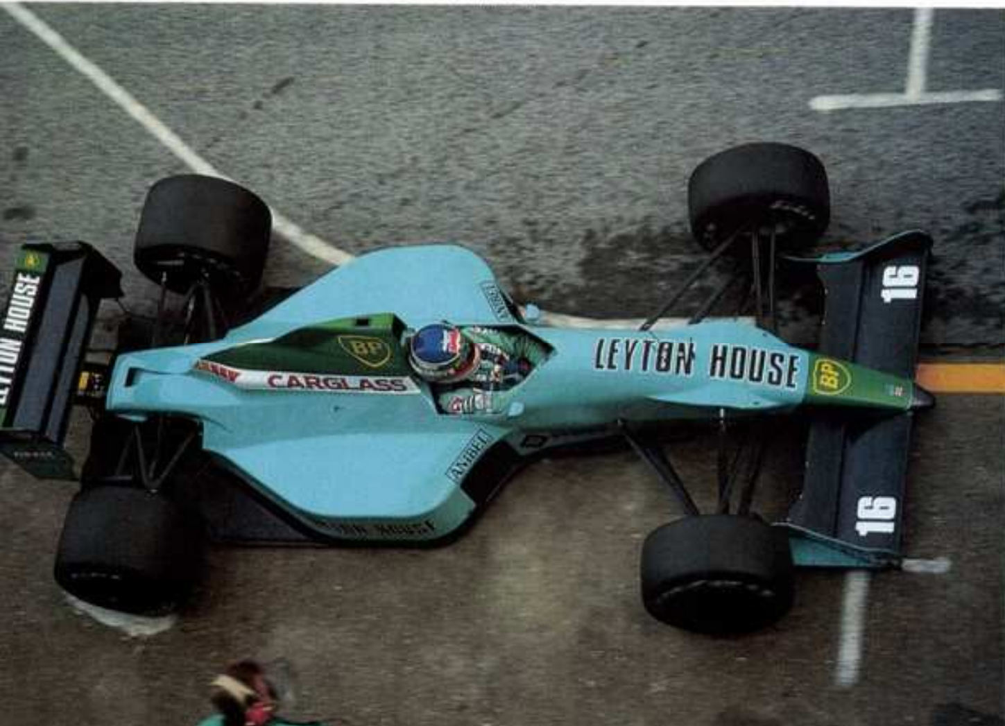
ウイングに変更はないが、ノーズ部を太くし走行安定性を求めている
