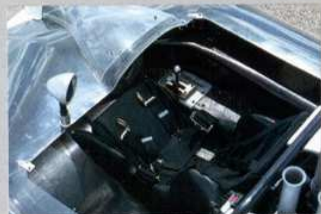
▲2の cockpit。当時のマシンとしては非常に効率的な作り。FRPモノコックは2→2D→2Fと使用され、再び2に戻された
