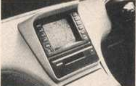
CCSは人工衛星から情報を得て自分の現在位置を確認できるGPSを装備したナビ・システムだ
