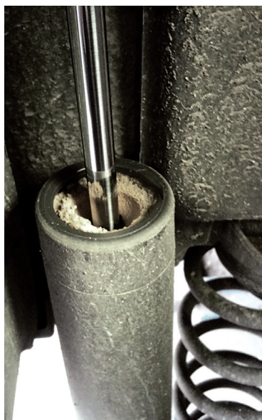
Часто механики не меняют защитный комплект, что приводит к повреждению и быстрому износу сальника
