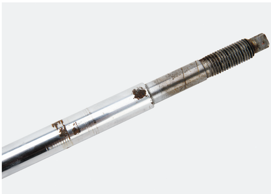
Образование ржавчины на штоке на участках, поврежденных при монтаже
