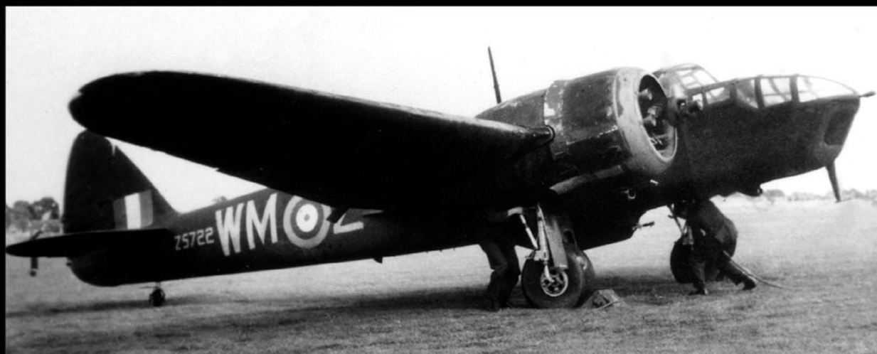
◀ Un Blenheim Mk. IVF (L5722) du N° 68 Squadron , équipé du radar AI Mk. I, à Catterick, début 1941. On note la gondole ventrale contenant l'armement fixe tirant vers l'avant. (RAF Museum)
