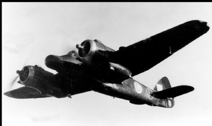
▲ Un Beaufighter Mk. IF (X7579) équipé à titre expérimental d'un radar AI Mk. VIII dans un thimble nose (nez en forme de dé à coudre). Cette disposition sera reprise sur le TF. X. (RAF Museum)
