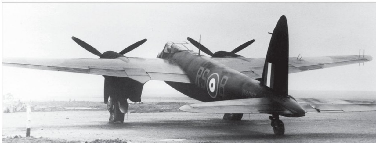
◀ Le Mosquito NF. II W4087 du N° 157 Squadron à Castle Camps, début 1942. On note les antennes réceptrices du AI Mk. IV sur l'aile droite. Ultérieurement confié au N° 25 Squadron , cet appareil sera équipé à titre expérimental d'un Turbinlite. (Collection C. Goss)
