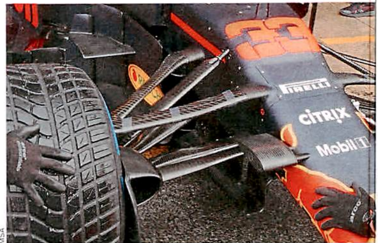
Bei Red Bull wachsen die Querlenker vorne weit oben aus dem Chassis
