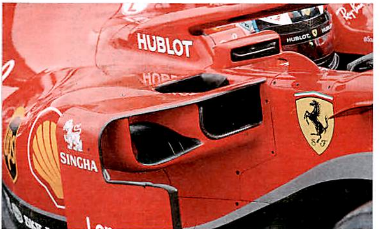
Ferrari hatte den Trick mit den hoch angelegten Lufteinlässen 2017 erfunden
