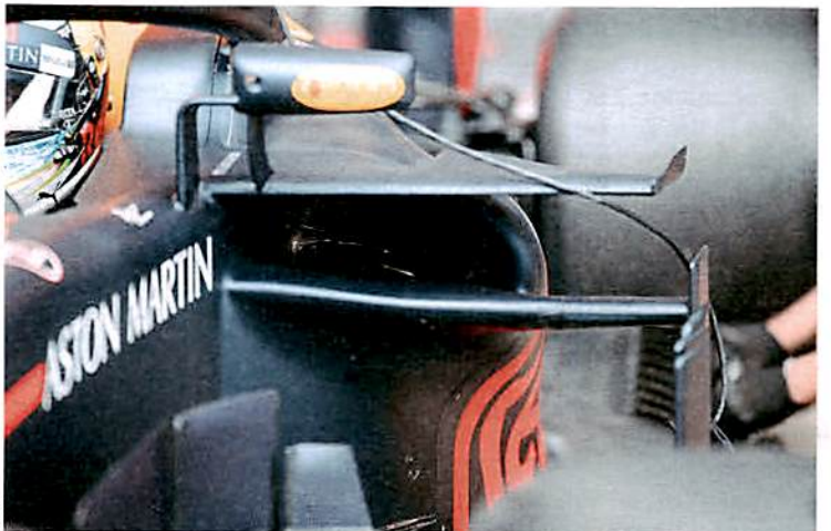
Im unteren Doppeldecker-Flügel sitzt beim Red Bull die Crash-Struktur
