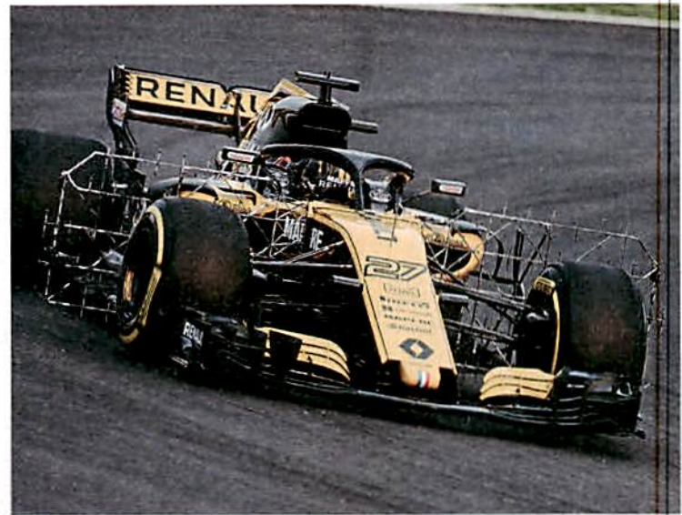
Fahrende Mess-Station: Renault testet mit Aero-Gitter
