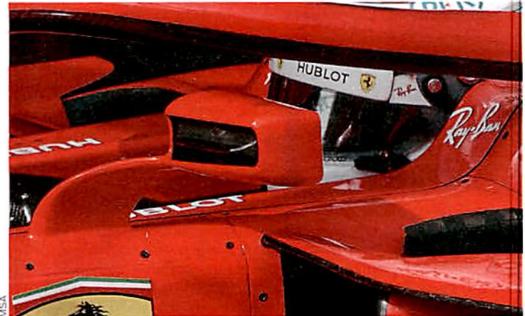
Die Ferrari-Ingenieure leiten die Luft neuerdings durch die Spiegel hindurch
