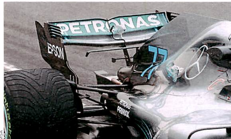
T-Flügel und Monkey-Seats werden jetzt an der Heckflügelstütze montiert
