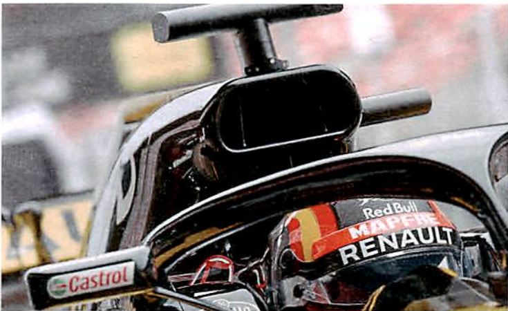
Die Airboxen werden immer breiter. Bei Renault sitzt der Ölkühler dahinter
