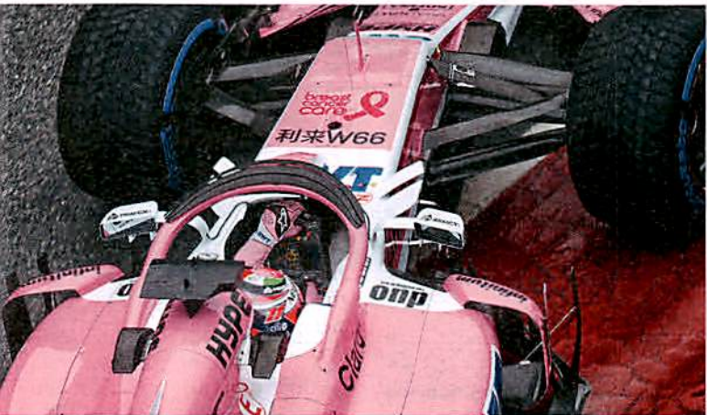
Der Halo am VJM11 von Force India ist in drei gestaffelte Ebenen unterteilt
