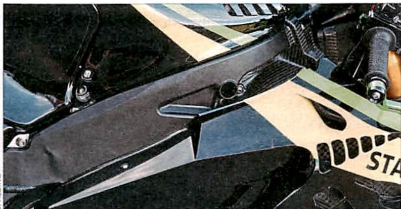
Gezieltes seitliches Nachgeben im Hauptrahmen durch Form und Materialstärke
