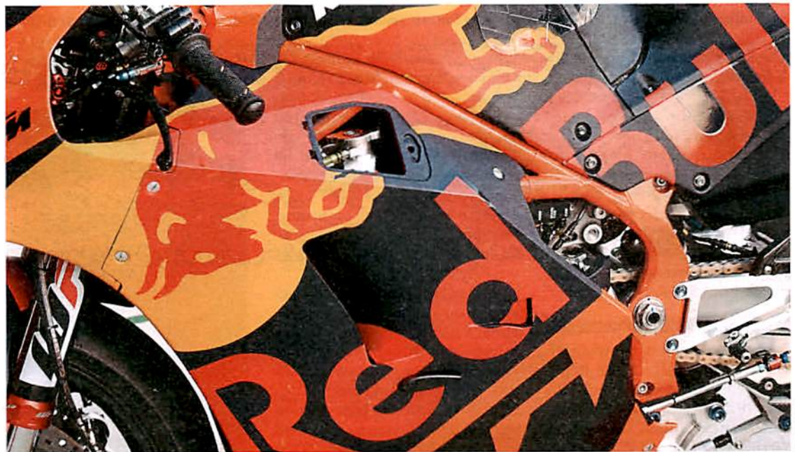
Geht auch mit Stahlrohren: KTM hat viel Erfahrung mit Gitterrohrrahmen und ändert den Flex durch deren Geometrie
