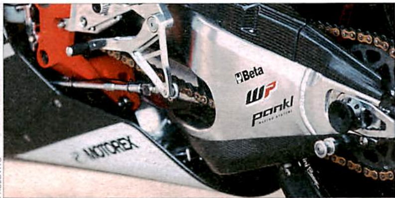
Auch die Hinterradschwinge ist ein kompliziertes Gebilde, das nur seitlich nachgibt
