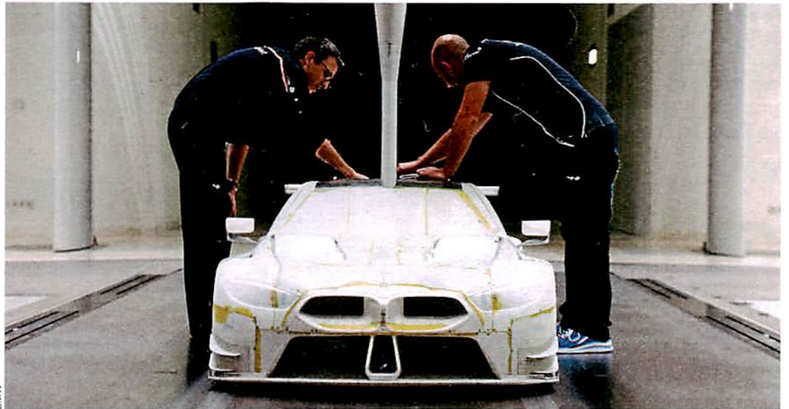
BMW führte über hundert Windkanalversuche durch, zunächst mit Modellen, später mit dem Fahrzeug selbst
