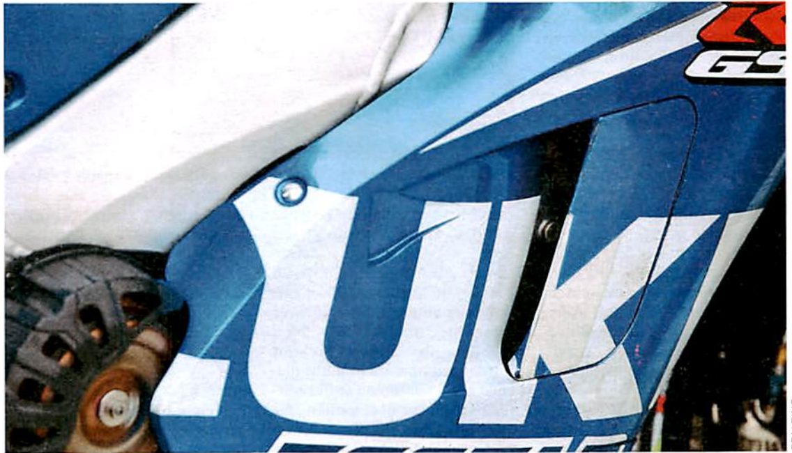
Suzuki benutzt eine austauschbare Kohlefaserplatte als vordere Motoraufhängung und kann so leicht den Flex ändern
