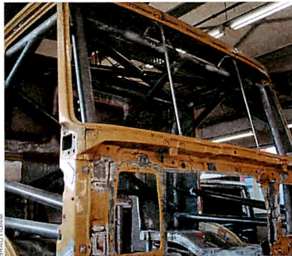
Rohes Rohrgeflecht: Die noch leere Fahrzelle
