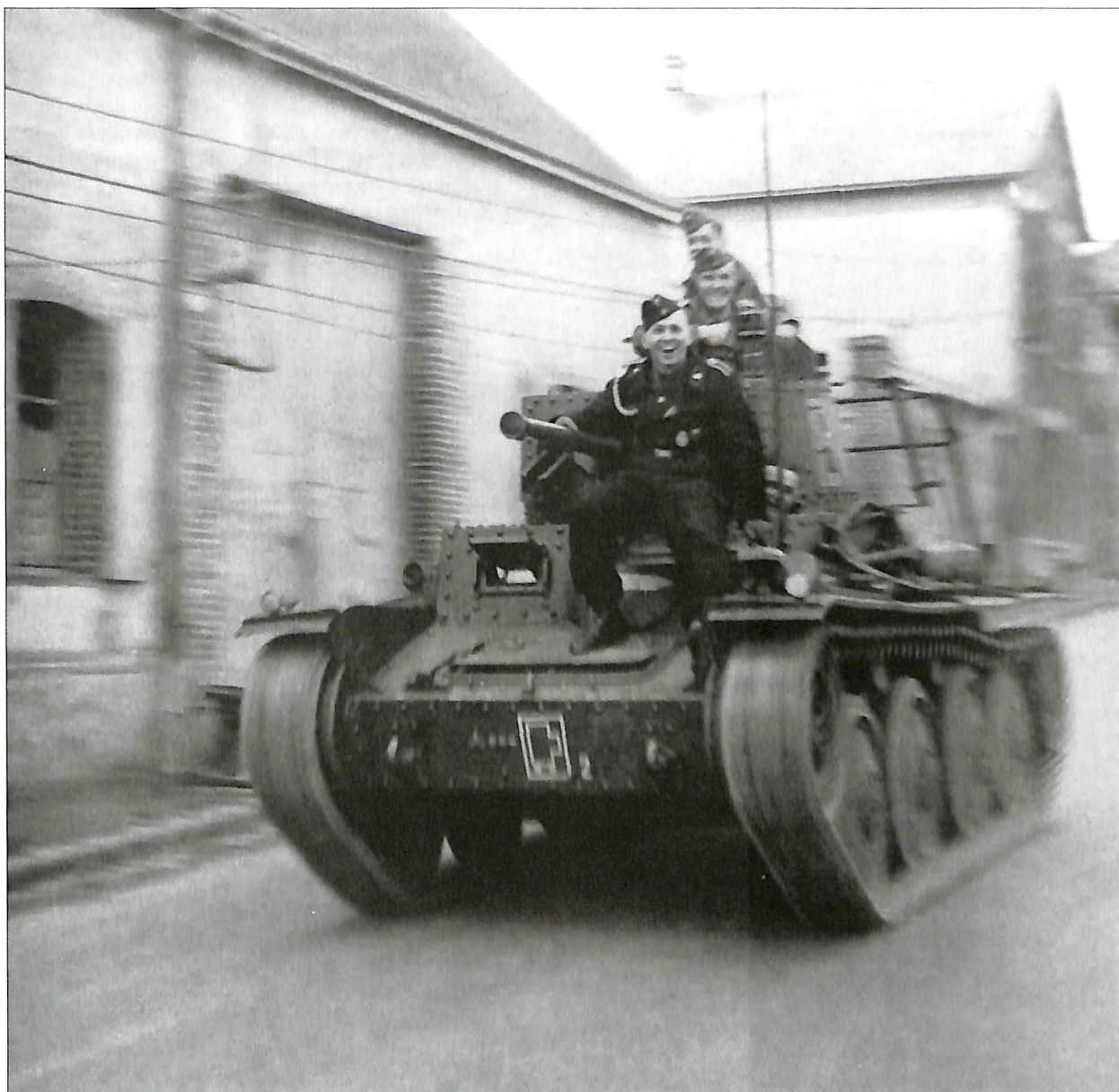
◀ Ce Befehlspanzer 38(t) lancé à pleine vitesse, aux alentours des 40 km/h, appartient à la 7. Panzer-Division . L'ensemble radio FuG 8 SE-30 comprend un récepteur MW.E.c et un émetteur 30 W.S.a . La portée de ce dispositif est d'environ 50 kilomètres en radiotélégraphie et 15 kilomètres en radiotéléphonie, dans des conditions climatiques et géographiques favorables. Là encore, l'équipage préfère voyager à l'extérieur.
