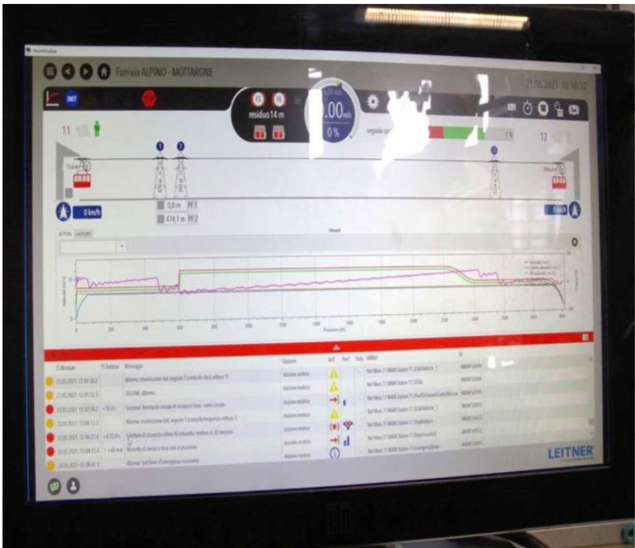
Abbildung 23: Fahrdiagramm der letzten Fahrt vor dem Unfall (Quelle: Digifema)
