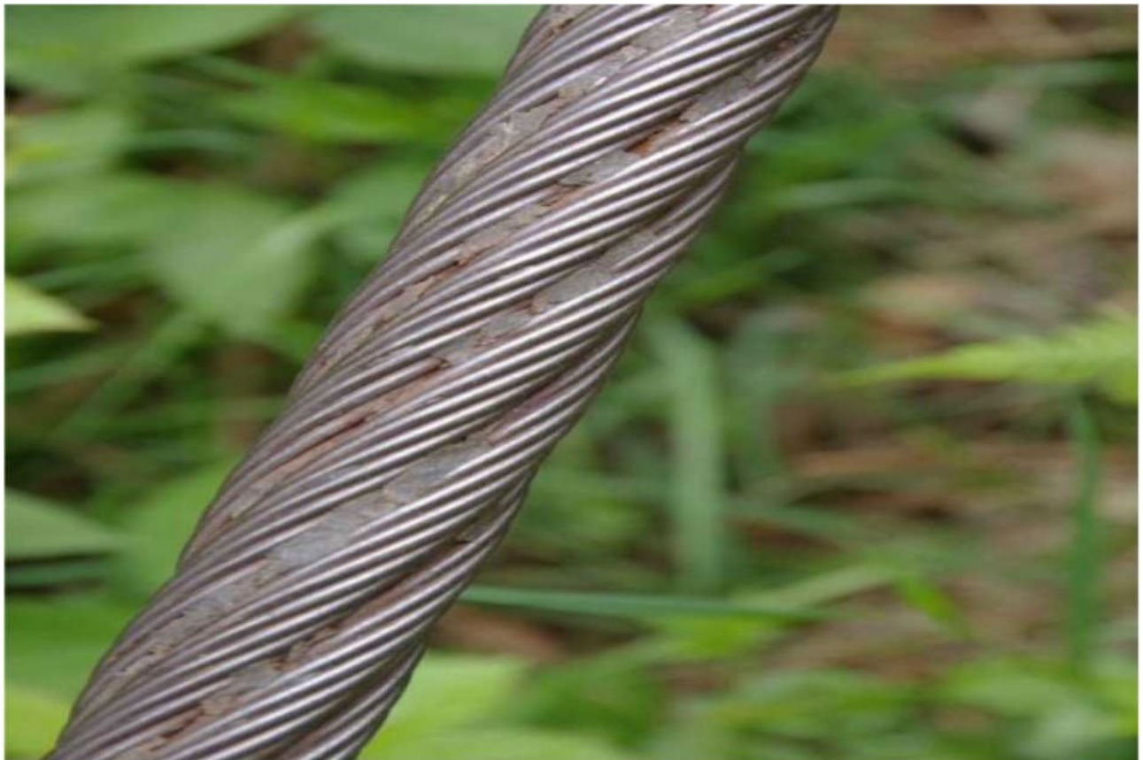
Abbildung 6: Gegenseil der Kabine 3, nahe der Absturzstelle (Quelle: Digifema)
