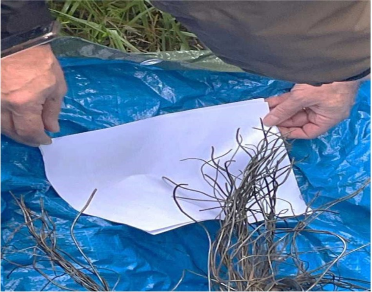
Abbildung 3: Zugseil nahe des Seilrisses (Quelle: Internet)
