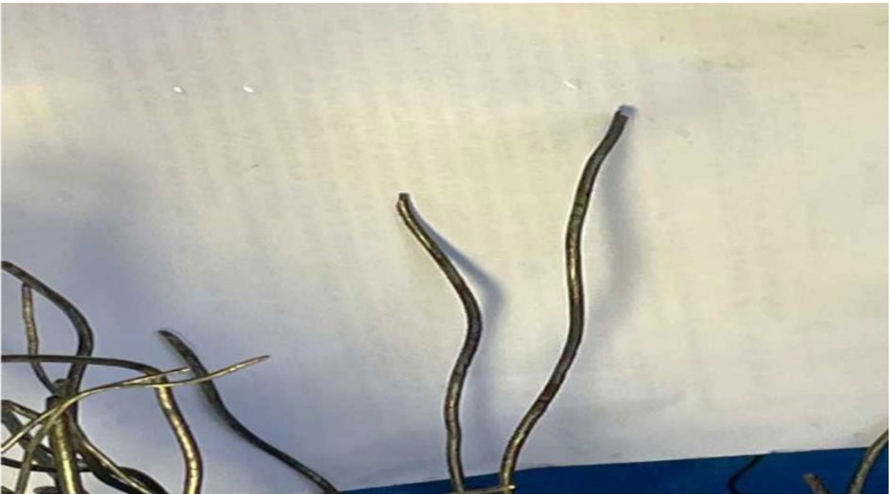
Abbildung 4: Drähte mit Anzeichen von Ermüdungsbrüchen und Korrosionsspuren (Quelle: Internet)
