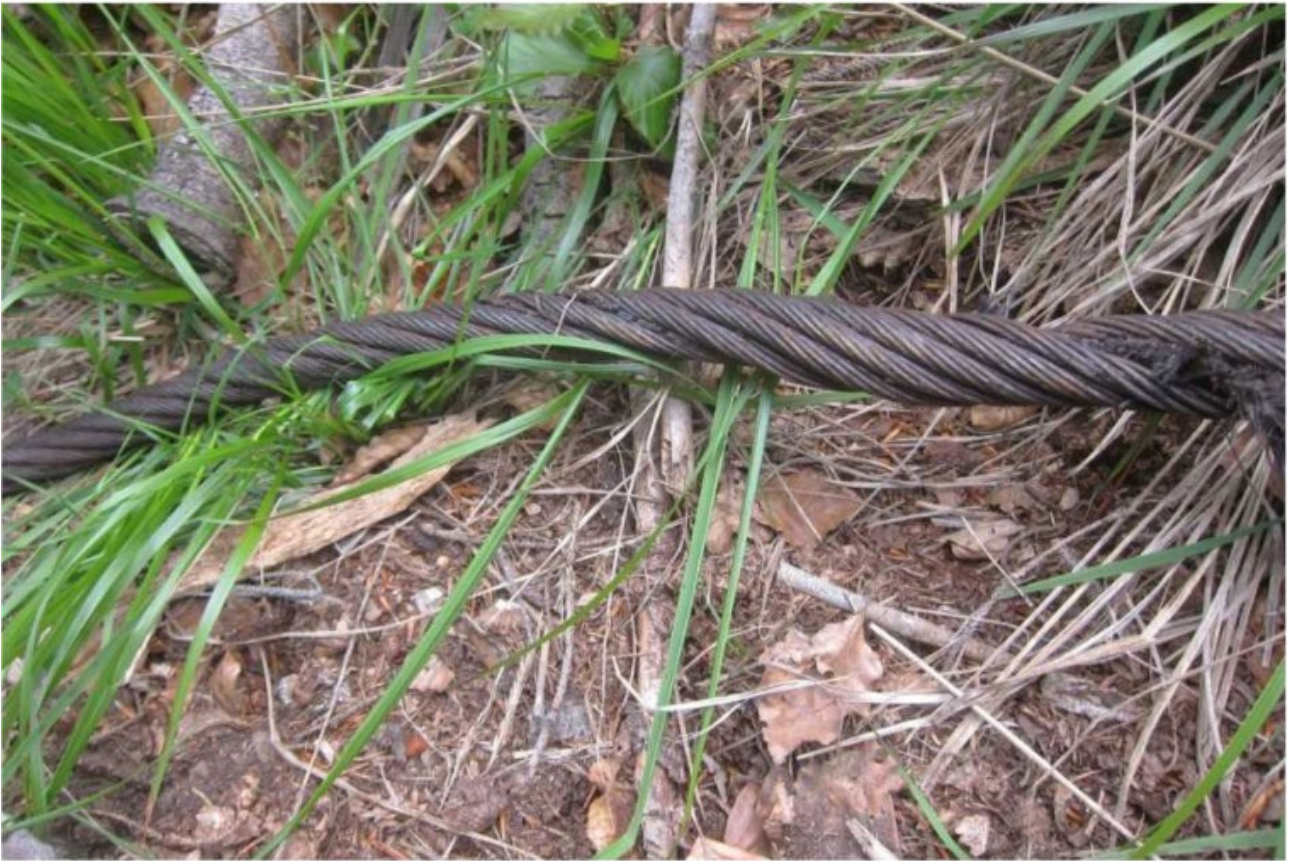
Abbildung 5: Seil nahe des Seilrisses. Beachtenswert die Korrosionsspuren, sowie die gelockerten Litzen (Quelle: Digifema)
