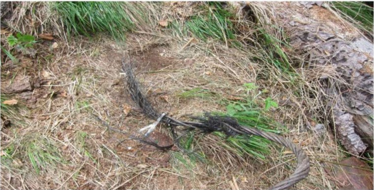
Abbildung 2: Zugseil nahe des Seilrisses (Quelle: Digifema)
