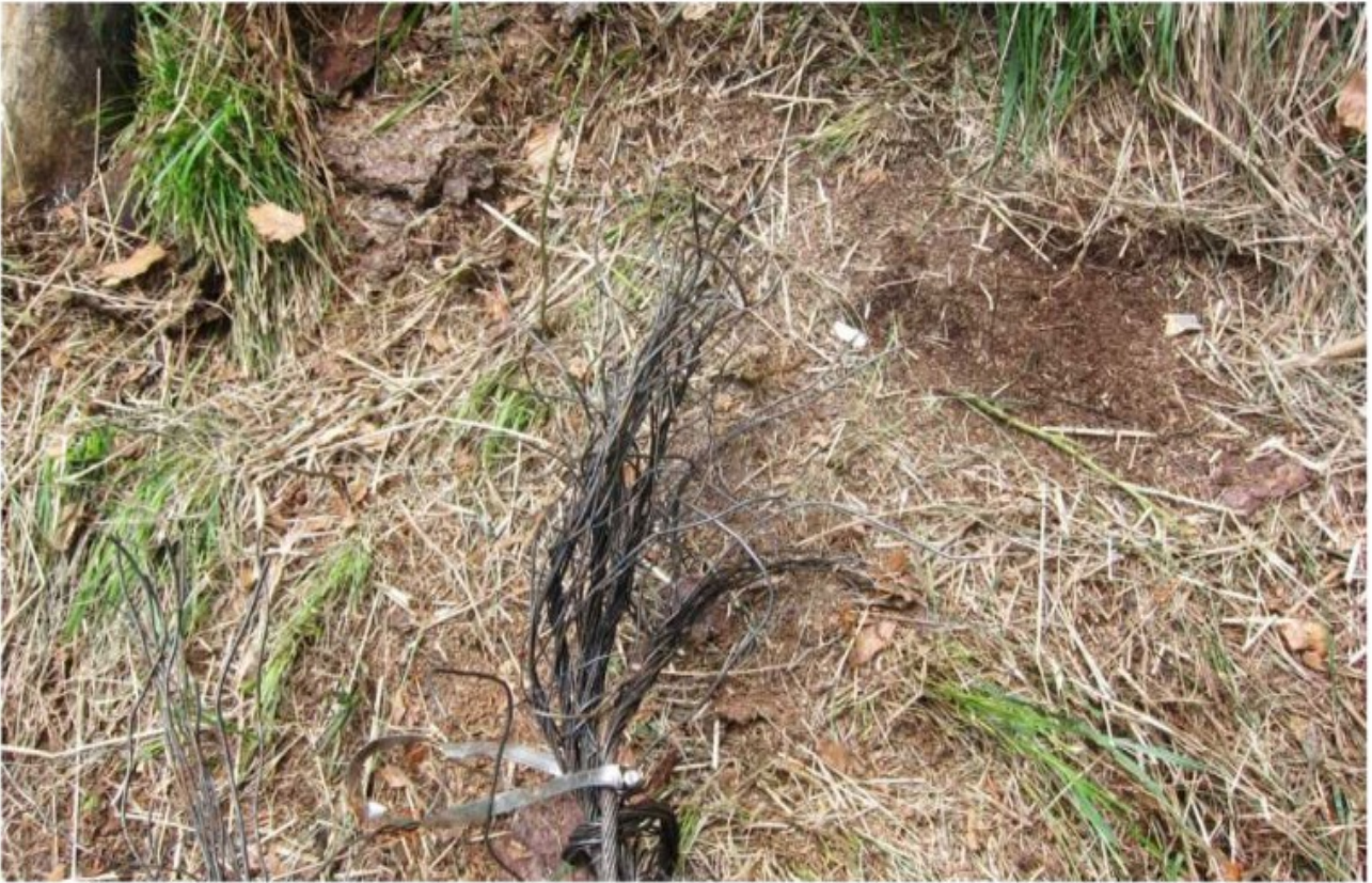
Abbildung 1: Zugseil nahe des Seilrisses. Auffällig sind das Erdungsband für den Sicherheitskreis, sowie die aufgebesten Litzen (Quelle: Digifema)
