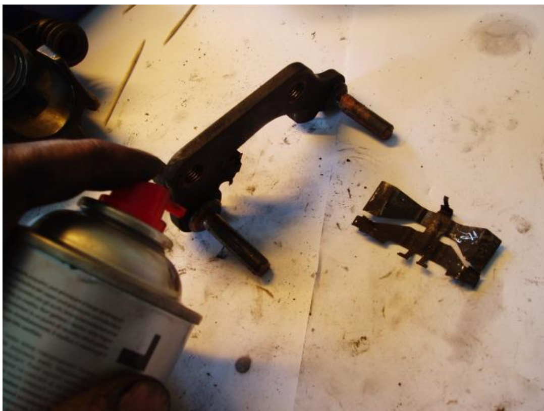
De rest van de onderdelen ook schoonmaken, nippel even doorspuiten met remmenreiniger
