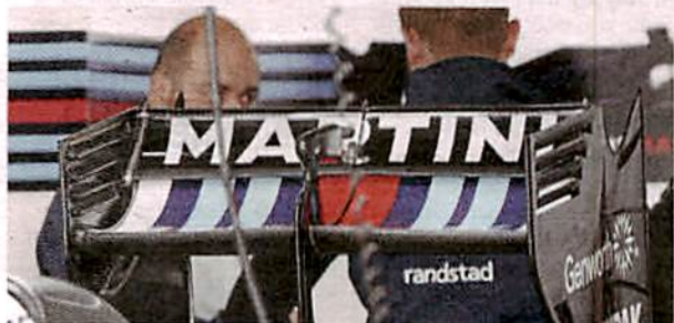
Klemmte bei Massa im Training: der aufklappbare Heckflügel
