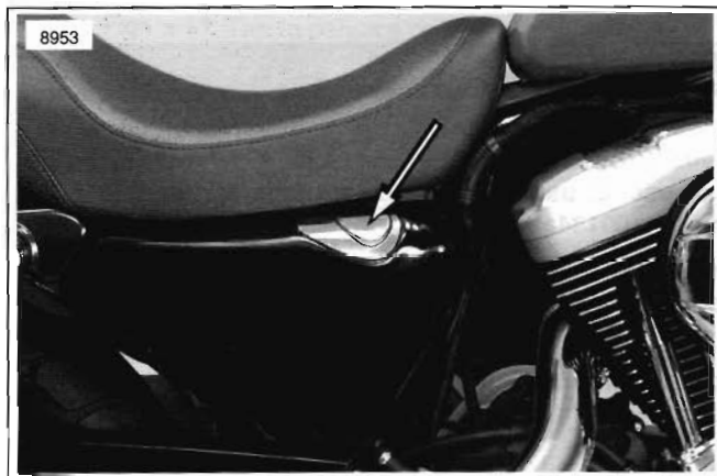
Figura 33. Ubicación de la varilla medidora (costado derecho)
