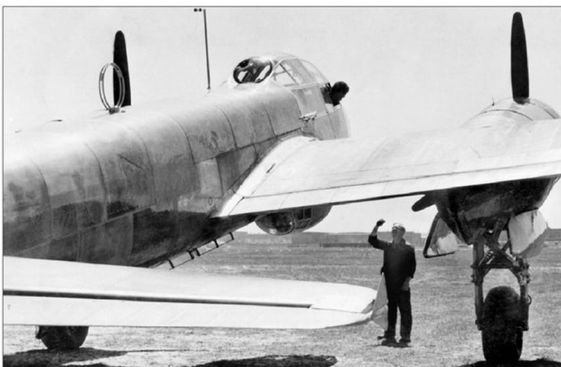
◀ Cette vue du Ju 88 V4 montre la disposition de l'armement défensif arrière. (Collection William Green)
