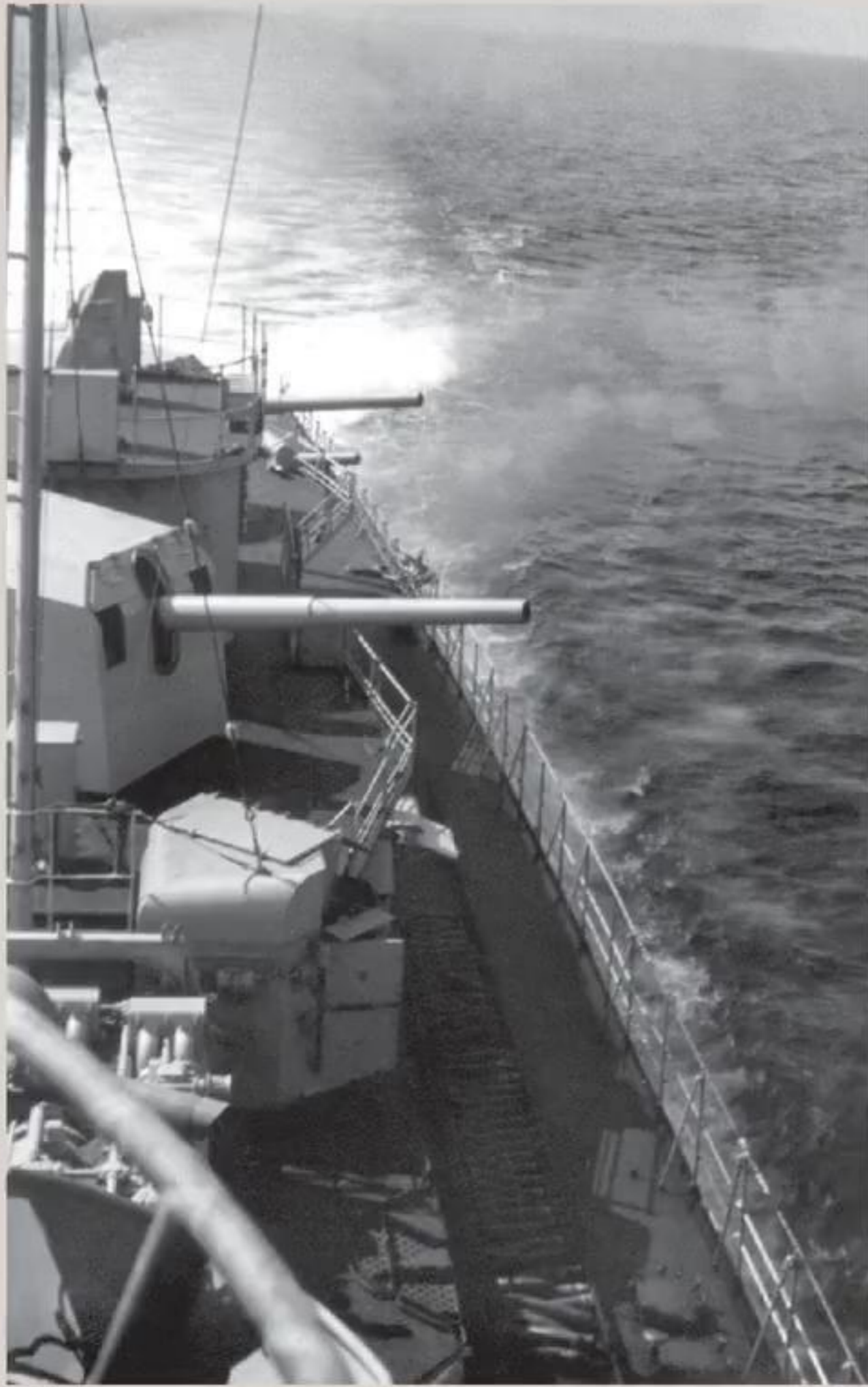
Photos de l'encadré : Différentes vues de Zerstörer Typ 1934A , de la classe précédant directement celle du Z-20 . Ces unités possèdent le même armement principal : 5 pièces de 12,7 cm sous masque blindé et deux affûts quadruples lance-torpilles de 53,3 cm. Archives Caractère
