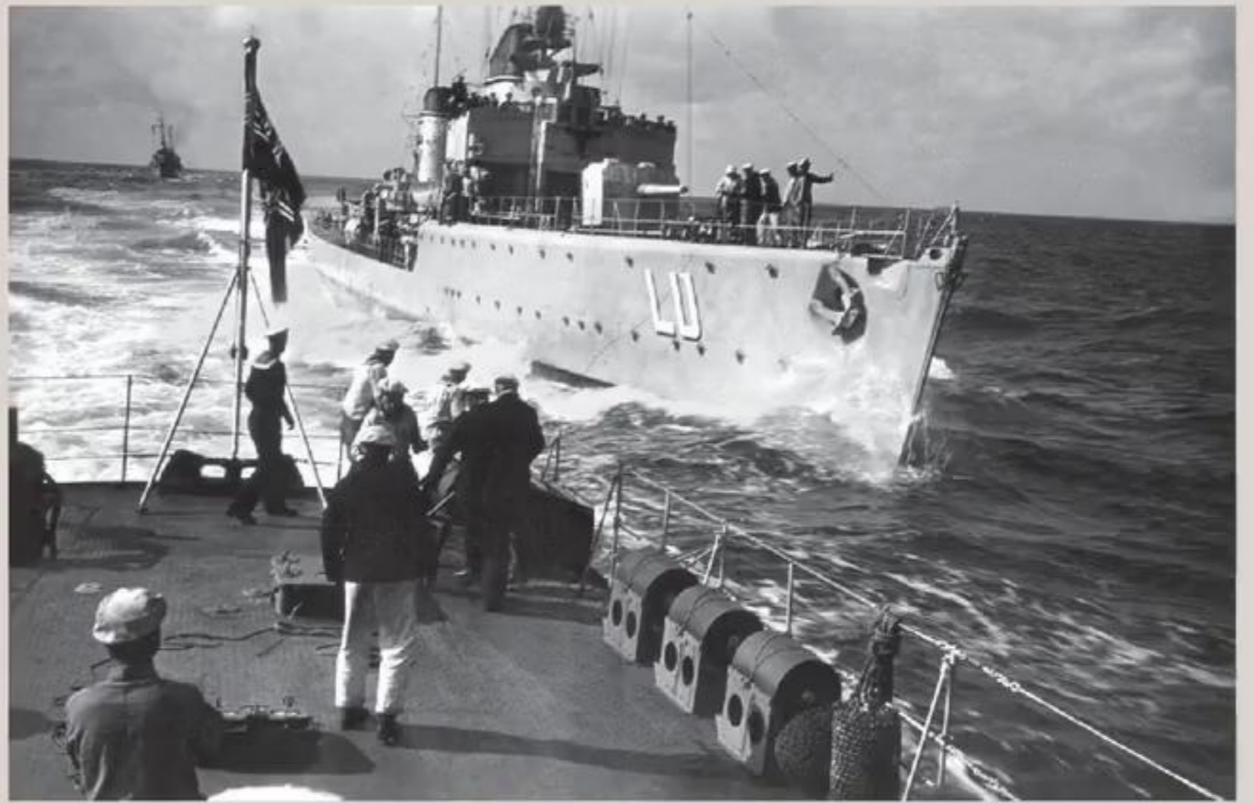
Photos de l'encadré : Différentes vues de Zerstörer Typ 1934A , de la classe précédant directement celle du Z-20 . Ces unités possèdent le même armement principal : 5 pièces de 12,7 cm sous masque blindé et deux affûts quadruples lance-torpilles de 53,3 cm. Archives Caractère
