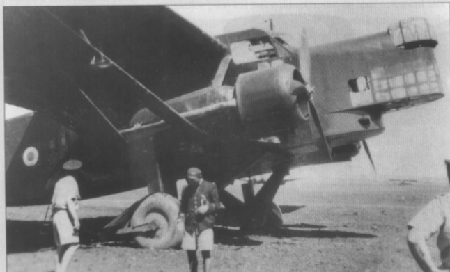
Un des Farman 221 à Tong. Cet appareil est dépourvu d'armement défensif, sans doute parce qu'il a été réservé à des missions de ravitaillement des unités françaises. (Collection J. Mutin)
