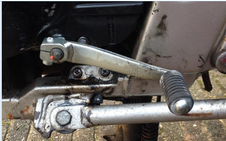
Nieuw schakelpookje, goed te zien aan het rubber. Speling die nog aanwezig was is op gelost met een speld (rode kopje). Dit pookje is ok.
