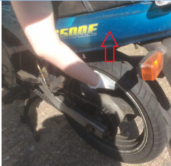
Schokbreker lagers: Trek het wiel (hard) omhoog. Bij speling zal het eerste stukje (te) makkelijk gaan.
