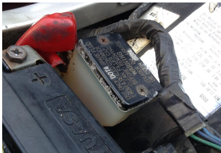
Een vol reservoir met schone remvloeistof
