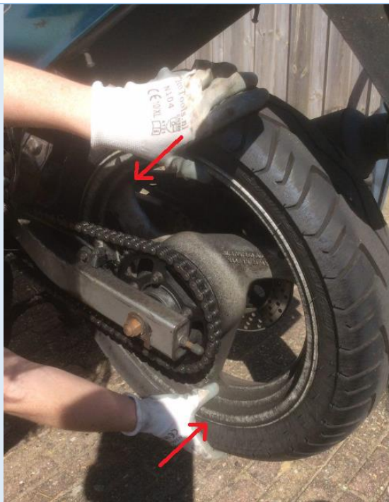
Pak het wiel boven en onder vast. Probeer hem te kantelen; er mag geen speling zijn.
