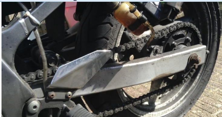
Geen kettingbeschermer aanwezig: Niet ok.
