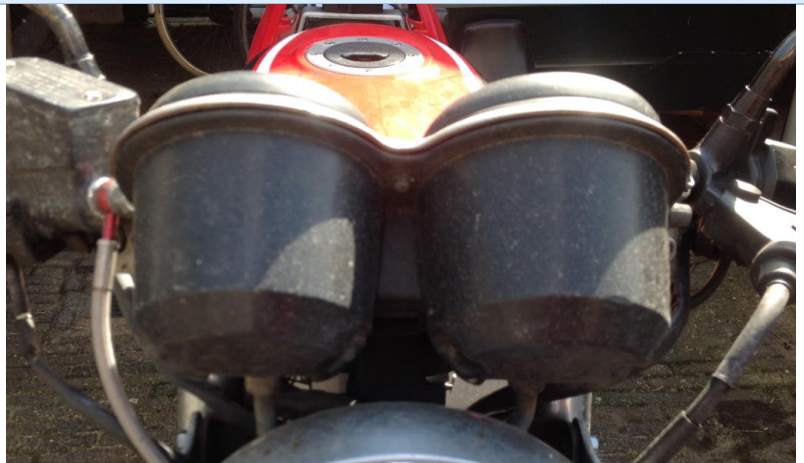
Tellerbehuizing niet gebroken
