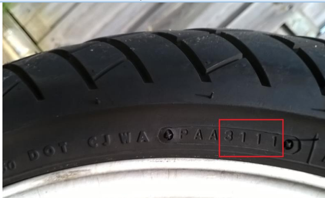
Deze band is geproduceerd in week 31 van 2011. De weergave kan iets verschillen per banden merk. Zoek naar de letters DOT en dan zal de code er in de buurt staan.
