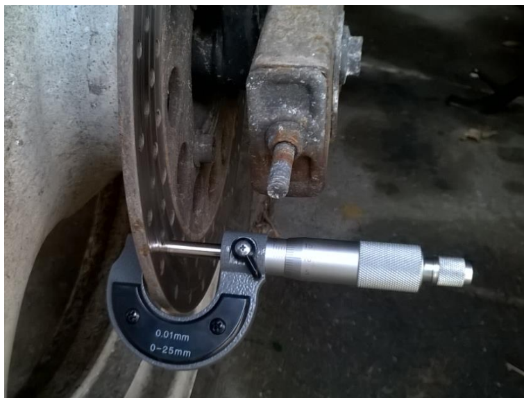
Meet de remschijven altijd op het dunste punt. De schijf is aan de rand dikker dus je zal een beugel-meter moeten gebruiken. Meet op een deel dat vrij is van roest.
