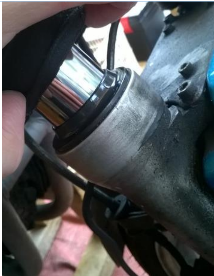
Natte stofringen en veel smeer rondom de poot duiden op lekkage
