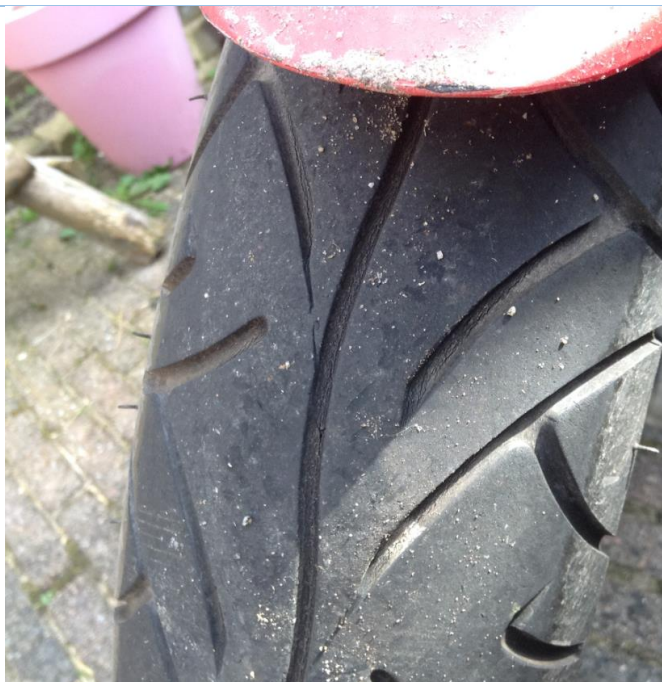
Uitgedroogde band met veel scheuren in het profiel
