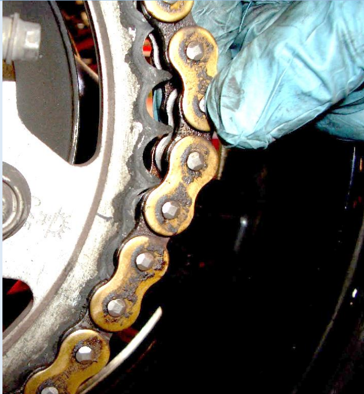
Deze ketting kan van het kettingwiel worden getrokken. De ketting is versleten.
