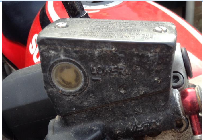
Een vol reservoir met schone remvloeistof
