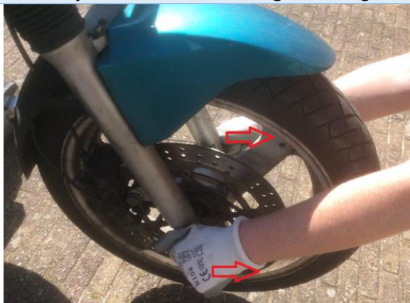
Trek het voorwiel (aan de as) naar je toe. Er hoort geen speling te zijn en het lager hoort niet te klikken.
