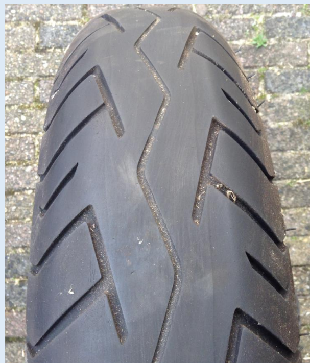
Een versleten achterband. 'Vierkant' afgesleten (weinig bochten gemaakt) omdat het profiel aan de zijkant nog dik aanwezig is.
