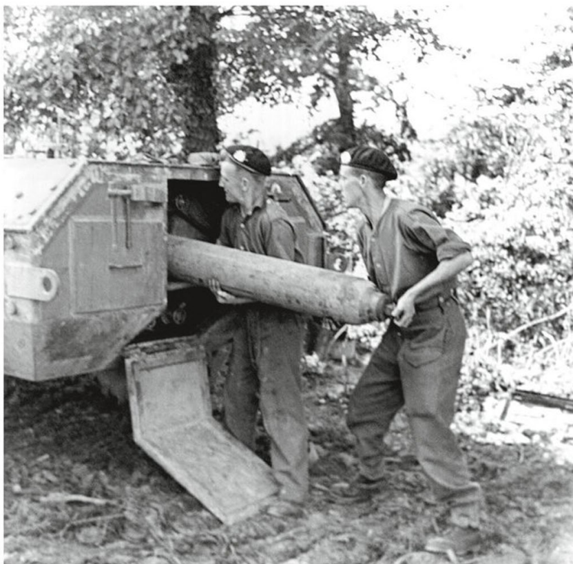
▲ L'équipage d'un Crocodile charge des bouteilles de liquide incendiaire et de nitrogène dans une remorque blindée. Les hommes doivent les vérifier fréquemment pour déceler les éventuelles fuites qui pourraient causer des dysfonctionnements au lance-flammes.
