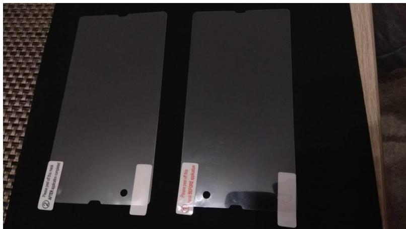
Na slici 2 se vidi postavljanje sloja sa brojem 1. Sloj 1. se odlijepi, pomjeri se dijagonalno za otprilike 1cm i zaliđe se ponovo nazad.
