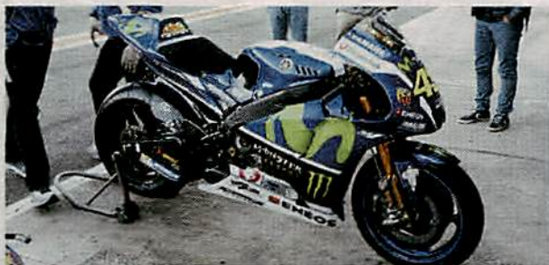
2017er Yamaha M1: Kürzerer Auspuff für mehr Leistung oben
