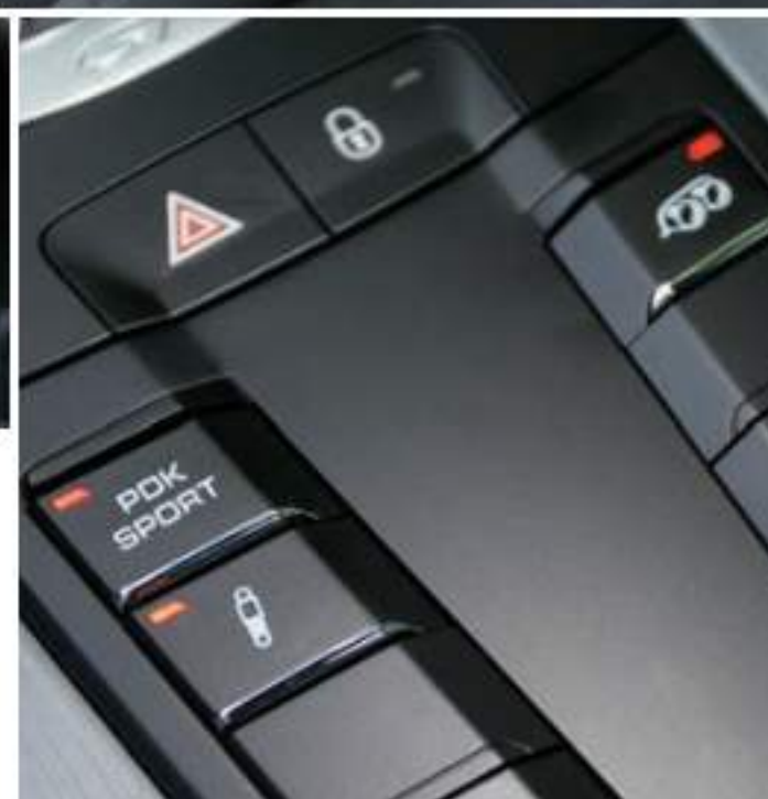
A középalagútról kapcsolható a váltó, a lengéscsillapítás és a kipufogórendszer sportos beállása
