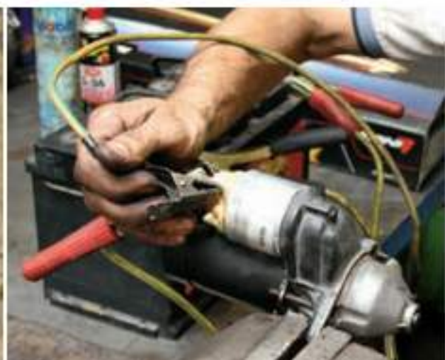
Az összeszerelt indító próbája a beszerelés előtt – ne hagyjuk ki!
