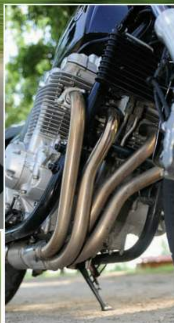
Gyönyörű látvány a léghűtési blokk és a 4 az 1-be csökögyő
