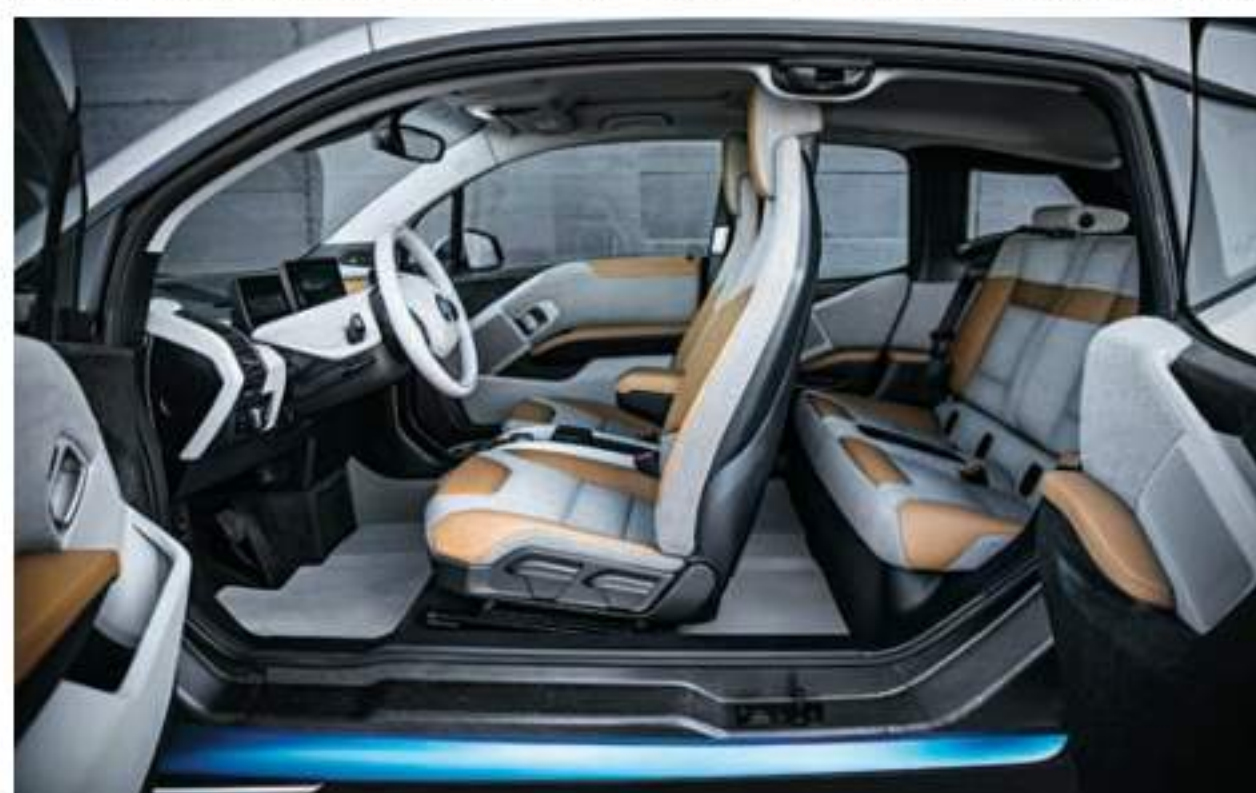
Az utascella szénszál erősítésű műanyagból készül
