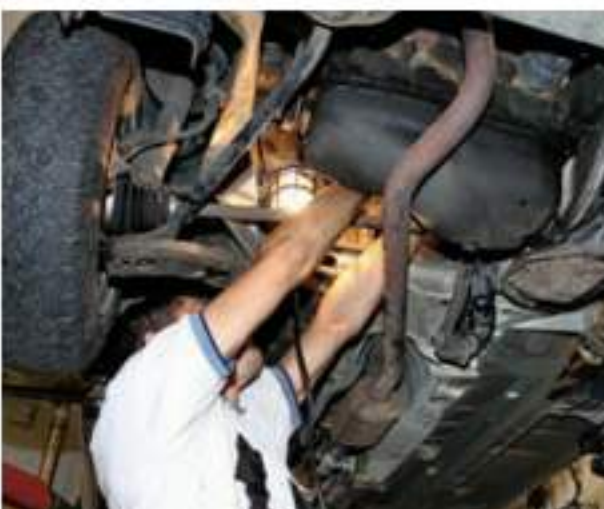
Az indító ki- és beszerelése általában nehézkes művelet
