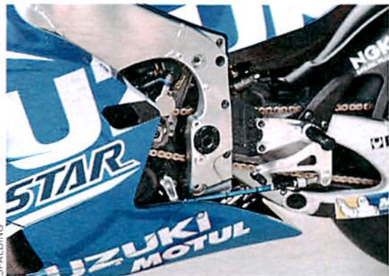
Der Rahmen wurde an der Schwingenlagerung verstärkt
