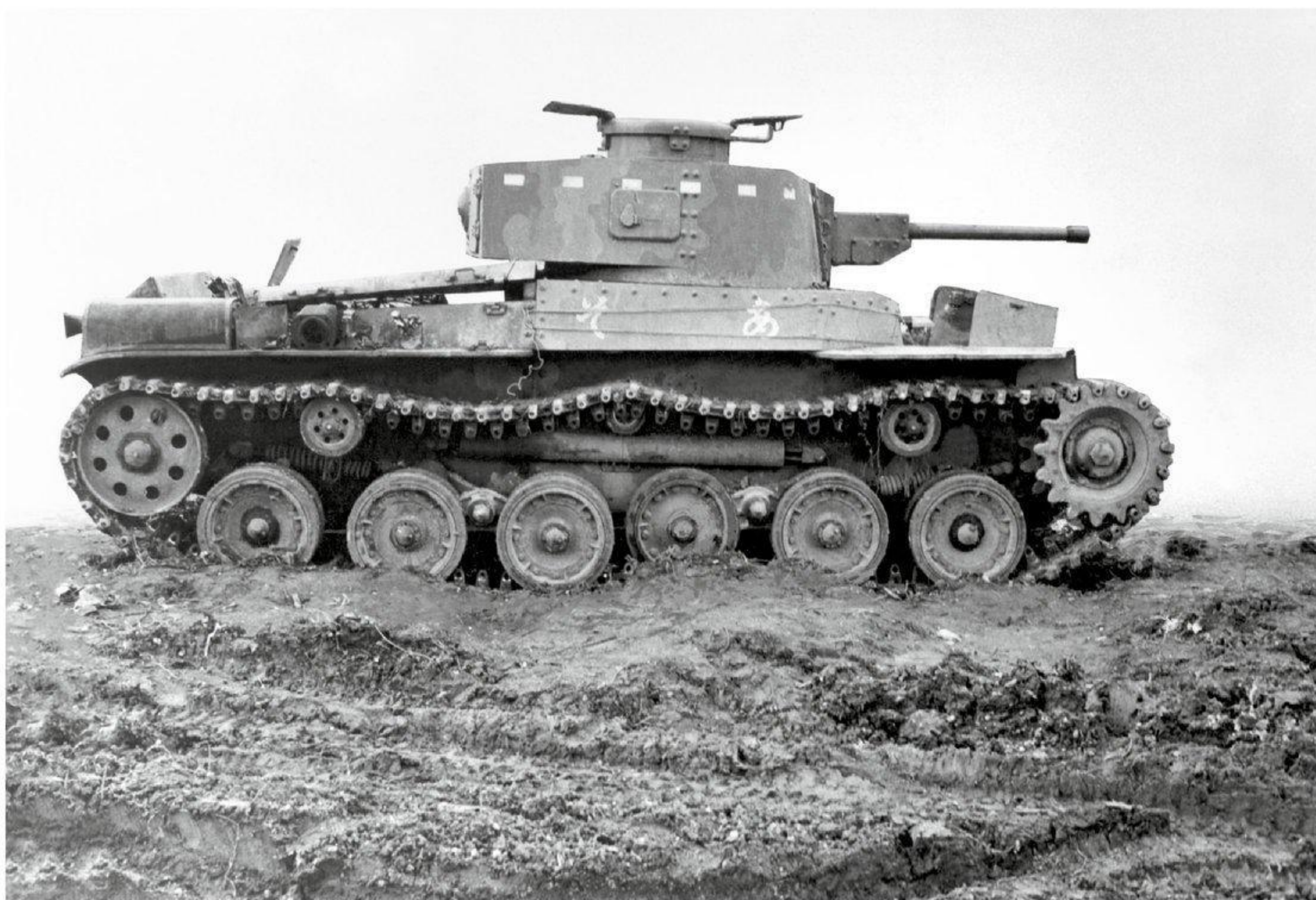
▼ Vue de profil d'un Type 97 Kai Shinhoto Chi-Ha. La taille de la tourelle a dû être agrandie pour accueillir le canon Type 1 de 47 mm aux performances supérieures. Cet exemplaire est le véhicule du commandant du 9 e régiment de chars, le colonel Masa Goshima, et a été capturé par les Américains Saïpan en juillet 1944.
