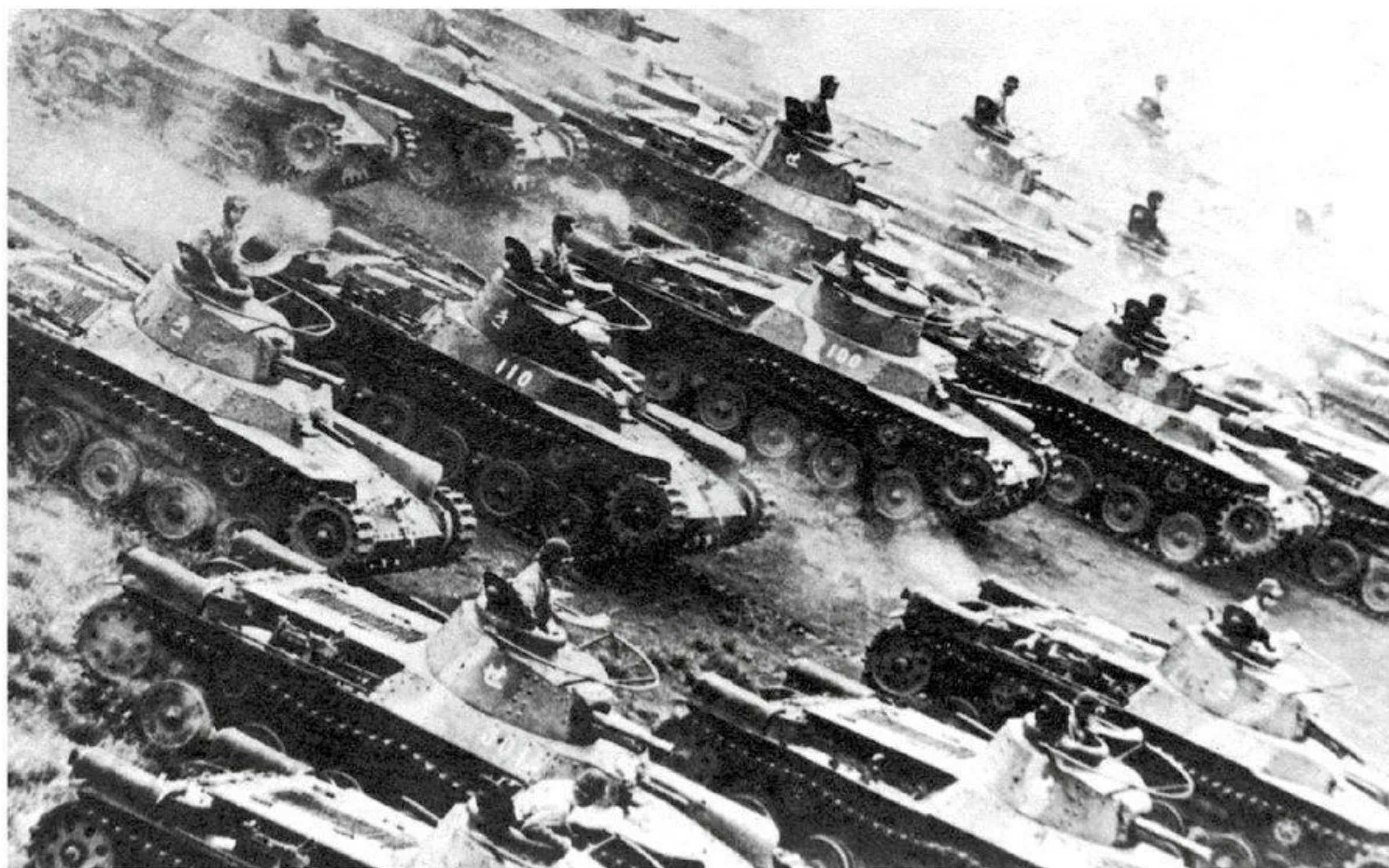
► Parade de Type 97 de l'école des blindés de Chiba durant la Seconde Guerre mondiale. Le Chi-Ha montre rapidement ses limites, raison pour laquelle les Japonais se tournent rapidement vers le Shinhoto.
