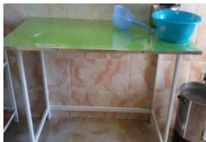
Газан плитканы суурь /60X120 хэмжээтэй өнгөт хавтан, хөлийг зориулалтын төмрөөр гагнаж хийсэн/
