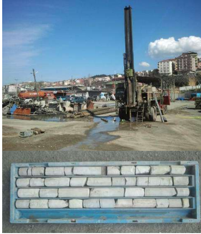
Şekil 2. İnceleme alanında yapılan sondaj çalışmaları ve karot sandığı.
