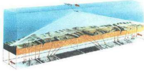
Şekil 5. Yandan taramalı sonarın kayıt formasyonu [3]
