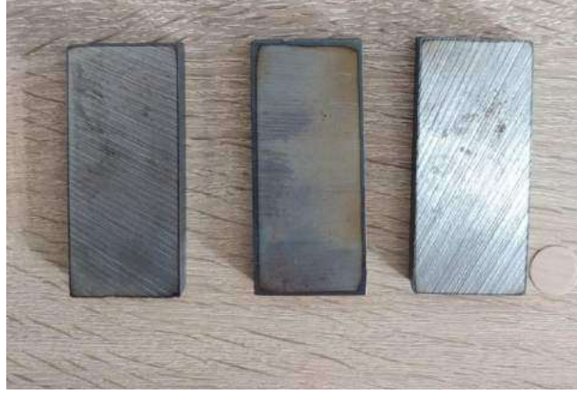
Şekil 3. Lazer kesimi yapılan dikdörtgen kesitli SAE 4340 çelik numuneleri.
