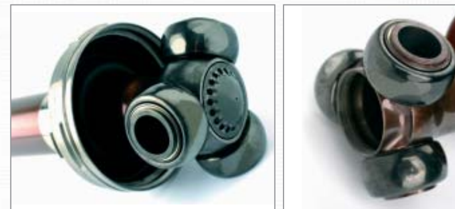
A mindkét végén hármas csapágyazású hajtótengely (vagy kardántengely) a gyors egyenesek végén percenként több mint 3 ezret forog
