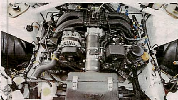
Tieflieger: Der Vierzylinder-Boxermotor mit 232 PS
