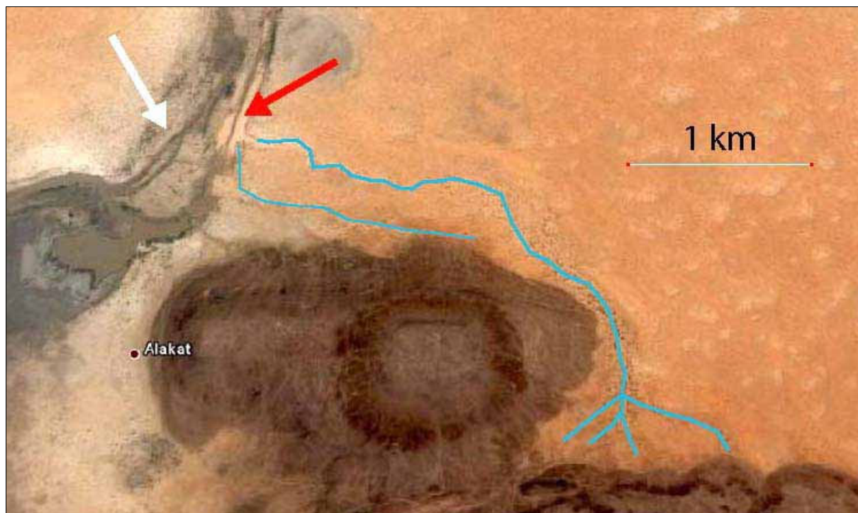
Fig. 15 Vue aérienne du seuil de Kamaina à la limite Nord du Lac Takara. Ce seuil limite les débits d'entrée du Lac Faguibine. Ce seuil rocailleux peut être couvert de vastes quantités de sable (flèche rouge) lorsque des pluies intenses sur les collines avoisinantes causent de l'érosion hydrique dans les oueds et dunes. La flèche blanche indique un cheminement alternatif plus à l'Ouest (Source: Google Earth image du 30 Mars 2007).
