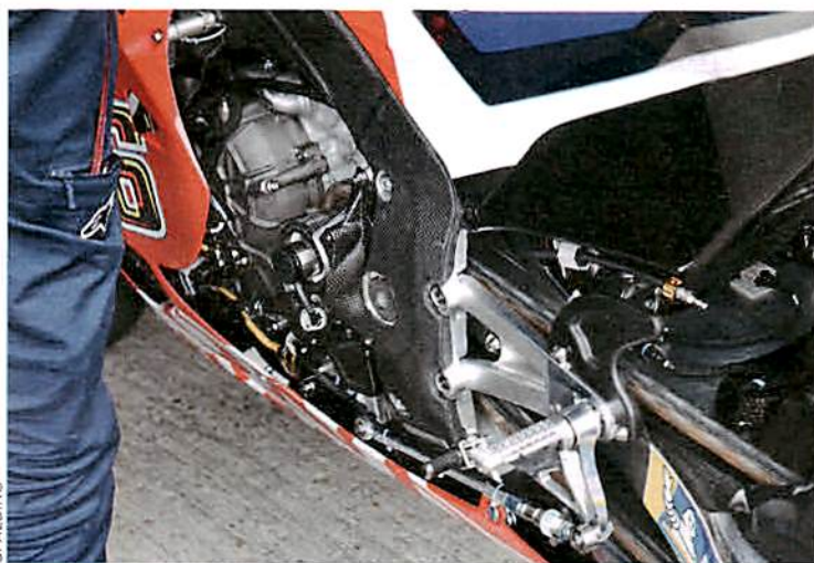
Honda-Prototyp von Stefan Bradl: Aufgeklebte Kohlefaser-Verstärkung
