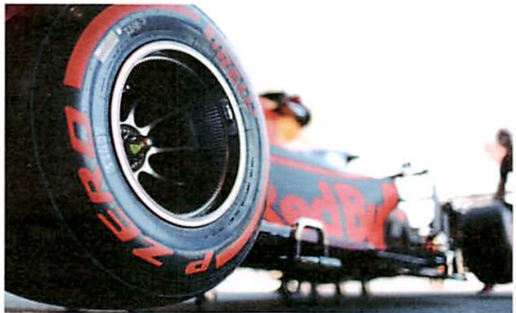
Ab 2021 rollt die Formel 1 auf 18 Zoll großen Rädern mit Einheitsfelgen
