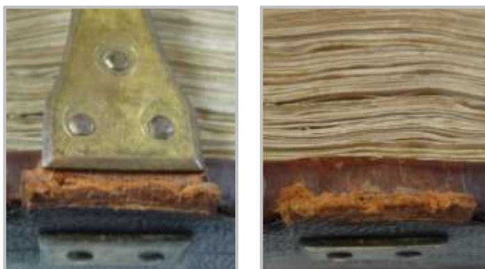
Afb. 1. Sluitklamp voor digitalisering. Afb. 2. Sluitklamp los geraakt na digitalisering.
