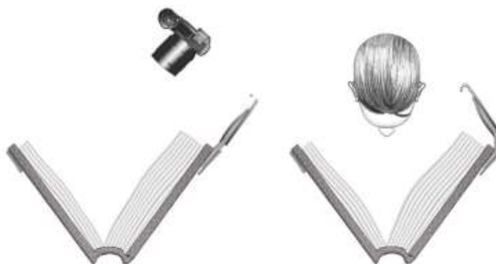
Afb. 33. Links: sluitingen bij digitalisering, rechts: sluitingen bij raadpleging op zaal.
