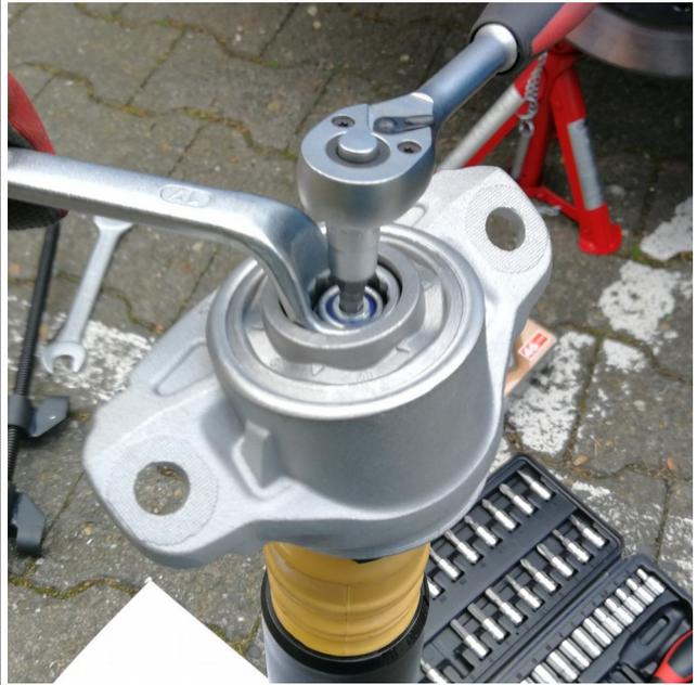
Beim Anziehen darauf achten, dass die Zugstufeneinstellungen im eingebauten Zustand nach außen zeigt. Später wird von den ausgebauten Dämpfern noch eine Plastikkappe zur Abdeckung auf den Stützlagern wiederverwendet.
