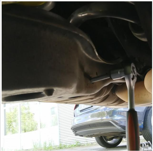
Die Zentrierhilfe im unteren Federteller entfernen, dazu von unten mit einem Schlitzschraubendreher die vier Haken Richtung Mitte drücken und Zentrierhilfe nach oben entnehmen. Den Steinschlagschutz entfernen, dazu zwei Clips mit dem Schlitzschraubendreher entriegeln und herausnehmen.
