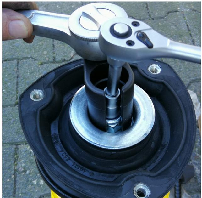
Unteren Federteller mit Spezialschlüssel bis ca. in die Mitte hochdrehen. Das obere Ende des Federdrahts muss im eingebauten Zustand zur Fahrzeugaußenseite zeigen.
