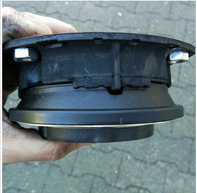
Kolbenstangenbefestigung (Mutter) des neuen Fahrwerks aufschrauben
