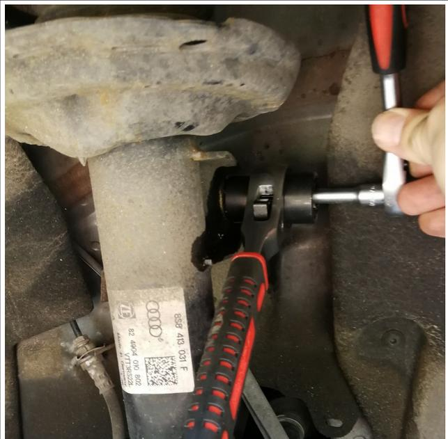
Nur auf der Fahrerseite: Die Gelenkstange des Niveausensors unten am Achslenker lösen (10er-Nuss von unten), dann das Gestänge nach oben bzw. hinten wegklappen, so dass es bei den weiteren Arbeiten nicht stört.
