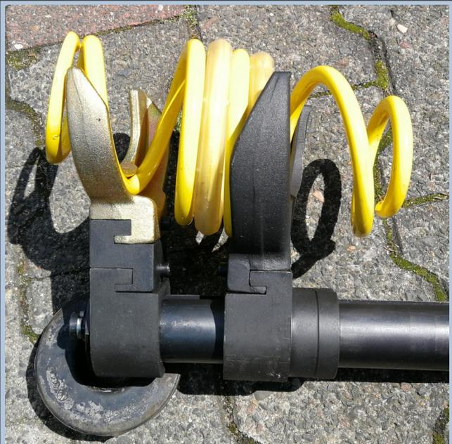
Die Feder erst unten einsetzen und dann oben mit Kraft unter die Aufnahme drücken, während man den Querlenker runter drückt. Falls die Feder sich nicht richtig einsetzen lässt, nochmal umspannen und erneut versuchen.
