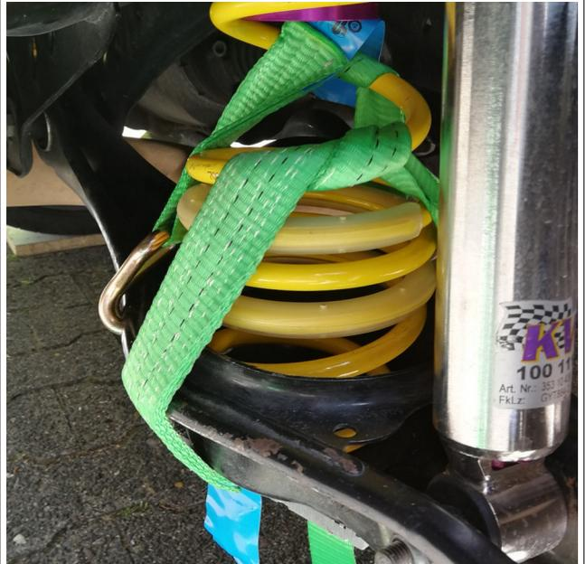
Den Spanngurt dann entfernen, Steinschlagschutz wieder dran, Räder drauf und Wagen ablassen. Die Distanz von Radmitte / Achse zu Radhausunterkante (Abstandsmaß B) ist nun wie gewünscht 35 mm (15 mm tiefer als Serie und etwas höher als vorne).
