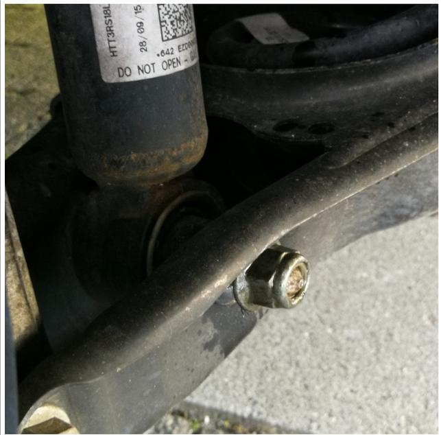
Den Querlenker von unten abstützen mit Holz, einem Unterstellbock o.ä., damit die Feder ihn nicht unkontrolliert wegdrückt, wenn eine Schraube gelöst wird. Danach die Schraube aus dem unterem Dämpferlager entfernen, der Dämpfer ist jetzt unten komplett lose.
