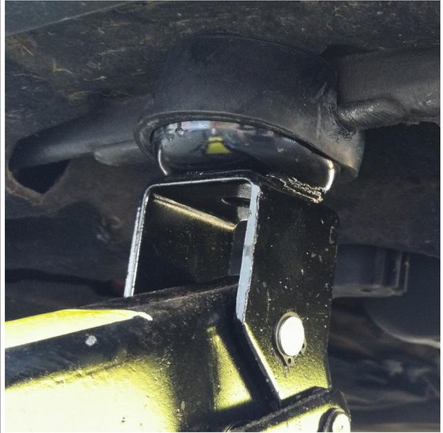
Am Querlenker die Schraube / Mutter des unteren Dämpferlagers und der Koppelstangenbefestigung mit WD40 einsprühen. (Ebenso die Schraube und Mutter des Radlagergehäuses bei der Variante ohne Federspanner.)
