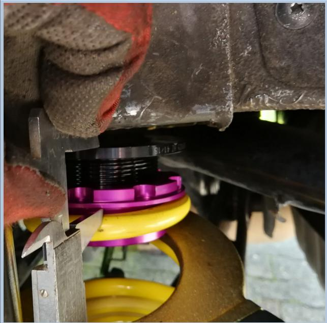
Die Feder vorsichtig entspannen, dabei die Position des unteren Drahtendes kontrollieren. Wenn der Federspanner entfernt ist, die Feder in die endgültige Position drehen, so dass sie vollständig und plan auf der unteren Auflage sitzt. Notfalls mit etwas Gewalt drücken und hebeln, bis alles passt.
