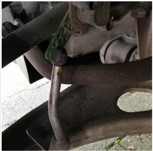
Mutter der Aufnahme des Federbeins am Radlagergehäuse mit 21er-Nuss lösen und kontern.
