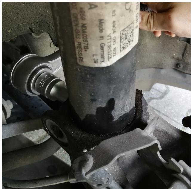
Zur Sicherheit den Achslenker schon mal von unten abstützen mit Holz, Unterstellbock o.ä., damit er später nicht unkontrolliert wegklappt. Die Hauptlast liegt natürlich weiterhin auf den beiden Wagenhebern. Diese Maßnahme soll nur verhindern, dass die Bremse durch das Eigengewicht auf den Boden knallt, sobald das Domlager losgeschraubt wurde.
