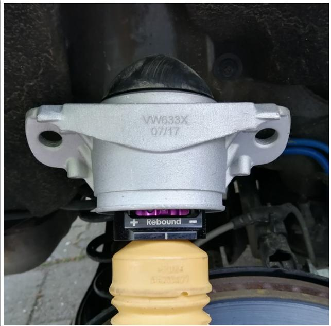
Den Dämpfer unten in den Querlenker einführen, die Schraube durchstecken, die Mutter aber erst in Leergewichtslage (im eingefederten Zustand) festziehen! Dazu Abstand Achsmitte zu Radhausunterkante durch Ablassen des Wagenhebers auf ca. 35 cm bringen, dann die Mutter mit 70 Nm + 180 ° anziehen. (Ebenso die Mutter des Radlagergehäuses bei der Variante ohne Federspanner.)
