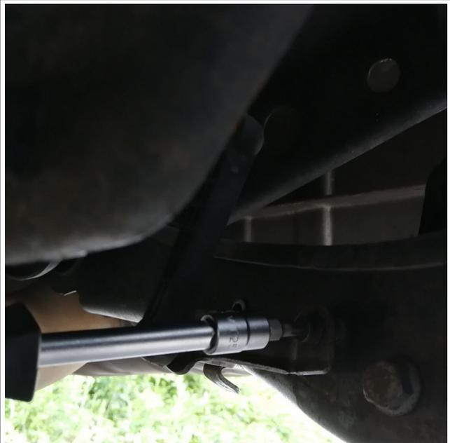
Schraube am Dämpfer unten mit 18er-Nuss lösen, Mutter mit 18er-Nuss kontern. Die Schraube aber noch nicht entfernen!
