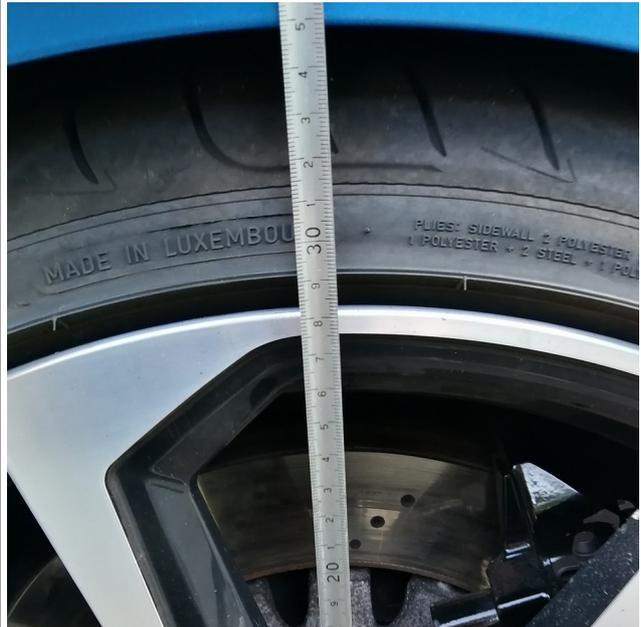
Wenn die gewünschte Tieferlegung erreicht ist, den einstellbaren Federteller mit der Inbus-Madenschraube sichern (max. 1-2 Nm). Auch eine Achsvermessung sollte erfolgen.
