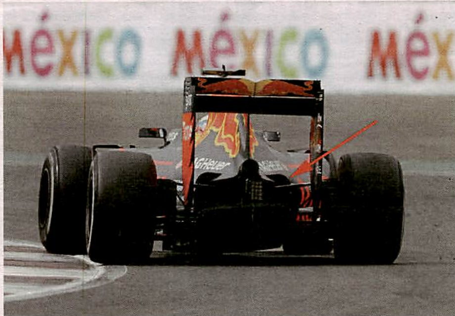
Hinten offen: Wegen der dünnen Luft besonders große Öffnungen in der Red-Bull-Motorhaube
