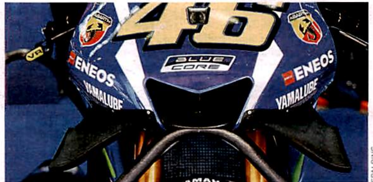
Seitliche Schaufeln bei Yamaha: Wirken beim Bremsen und Beschleunigen
