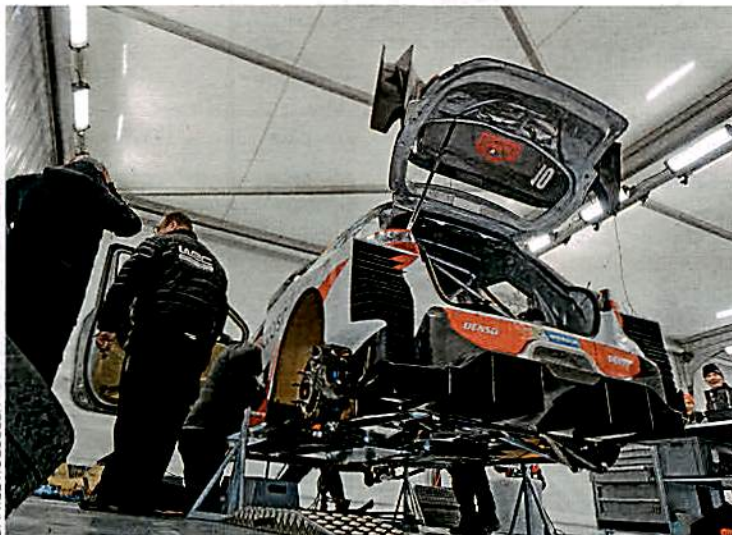
Die Maße vom Unterboden zum Federbeindom sind beim Toyota zu lang
