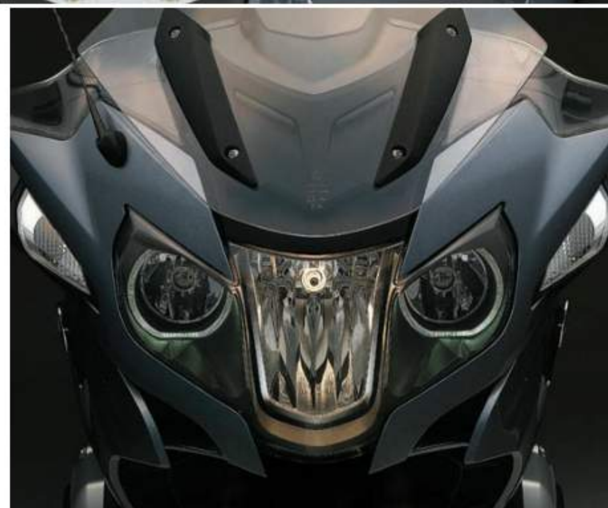
Intelligens rendszer: az R 1200 RT fényszórója sötétedéskor vagy alagútba érve a nappali fényről automatikusan tompítottá vált
