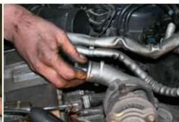
A csöveket ledugózzák, nehogy szennyeződés kerüljön a motorba
