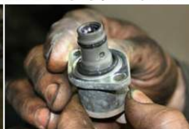
A kiserelés után természetesen a hozamszelepet is megtisztították
