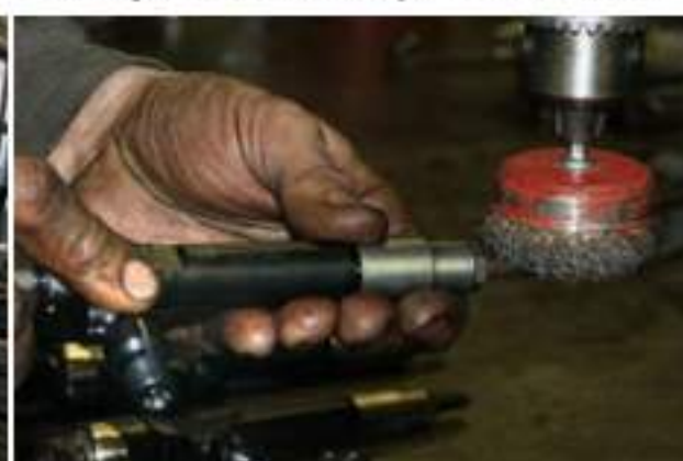
Nagyoló pucoláson a fűvőkák. Rendszeres karbantartás kéne...
