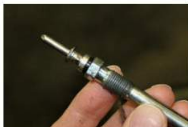
A finommenet érzékenyebb a korrózióra, könnyebben megszorul
