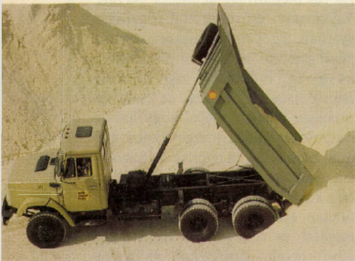
A teleszkóp 60 fokos szögig emeli a billenőplatót Fotó: BALOGH RÓBERT
