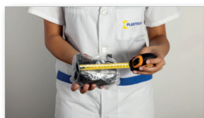
Controllare le dimensioni degli elementi da saldare.
