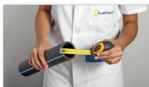
Controllare le dimensioni degli elementi da saldare.
