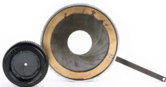
Irisblenden kommen in unterschiedlichen Größen zum Einsatz: links die Blende aus einem Großformatobjektiv, rechts die Blende aus einem verstellbaren Scheinwerfer.
