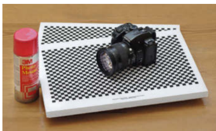
Selbstgebastelte Testtafeln für den Adobe Lens Profile Creator aus dem Druck des Testmusters, Leichtschaumplatten und Sprühkleber.
