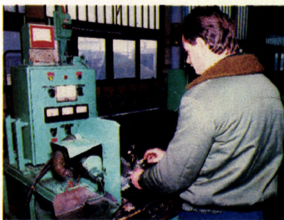
A motorok először próbapadon vizsgálnak. A műszereken a fordulatszám és az elektromos berendezések adatai követhetők figyelemmel
