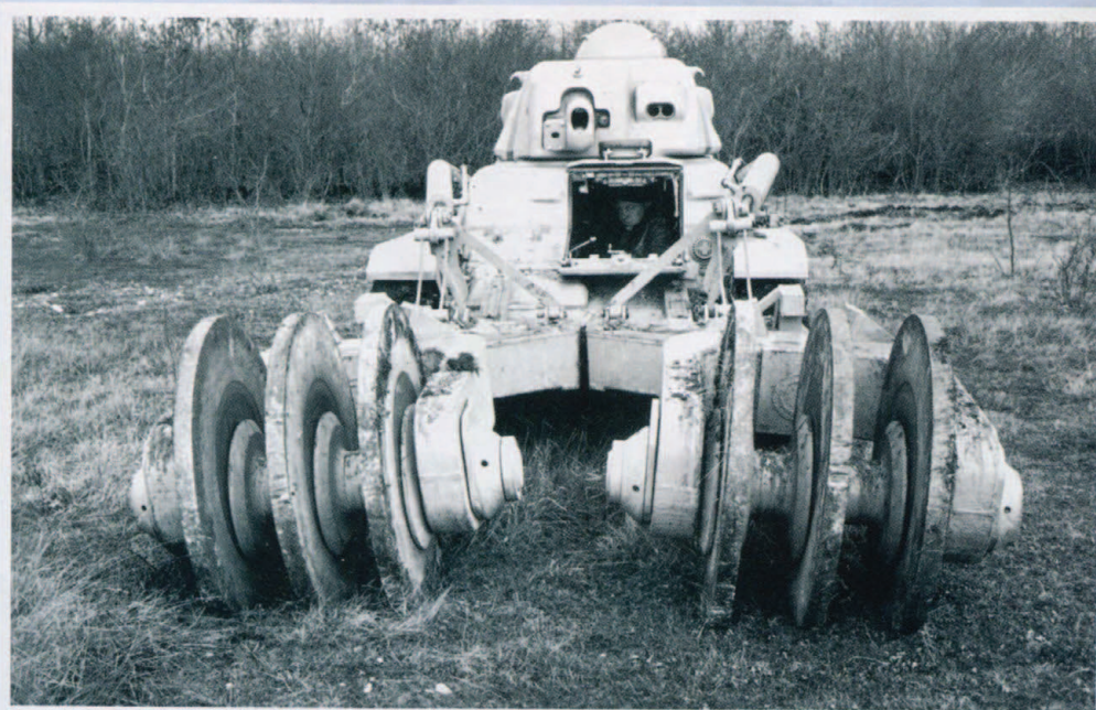
« Saute-mines » à disques AMX type SY3 en position de travail. DGA Châtelleraut via Pascal Danjou
