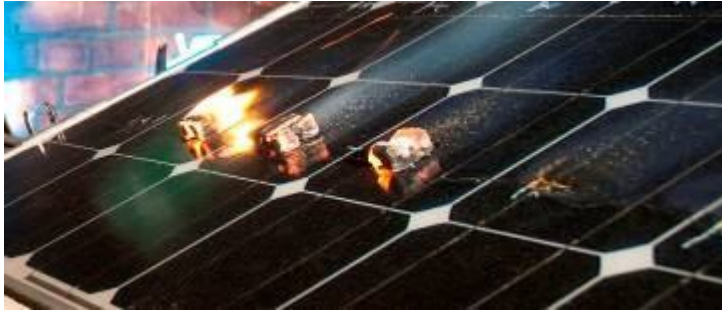
Burning Brand test: C Sınıfı PV-Modülleri için asgari gereklilik
