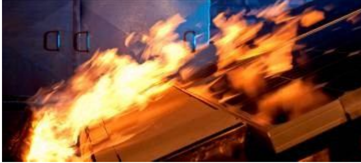
Spread of Flame test: Modülün üst tarafının alevlenmesi
