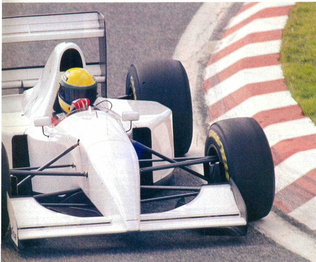
Una monoposto tutta bianca, chiaramente provvisoria. È la McLaren spinta dal dodici cilindri Chrysler-Lamborghini durante le prove all'Estoril, dove l'hanno pilotata sia Hakkinen, a sinistra, che Senna, sotto. Il telaio è quello della Mp4/8, abbinato al retrotreno della Mp4/7 che montava il V12 Honda. A destra uomini di Lamborghini e McLaren ai box
